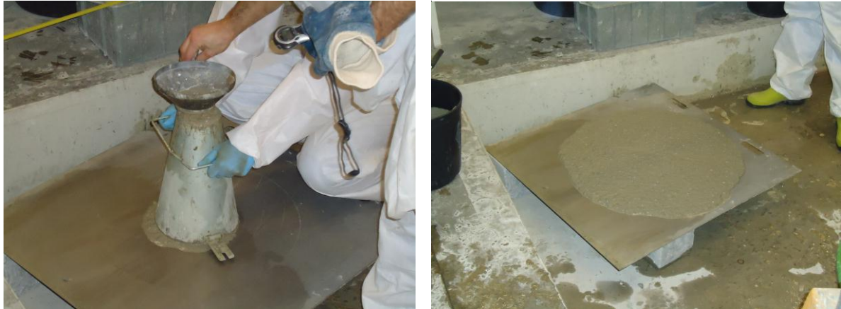
Fig.4.8 - Esq.: Cone de Abrams; Dir.: Betão espalhado ao qual se mediu o diâmetro de acordo com [44]
