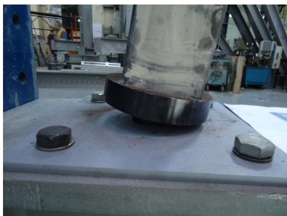
Fig.4.15 – Esq.: Cadilho utilizado no ensaio da primeira coluna; Dir.: Cadilho fabricado tendo em conta a carga máxima a ser aplicada
