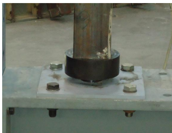
Fig.4.15 – Esq.: Cadilho utilizado no ensaio da primeira coluna; Dir.: Cadilho fabricado tendo em conta a carga máxima a ser aplicada
