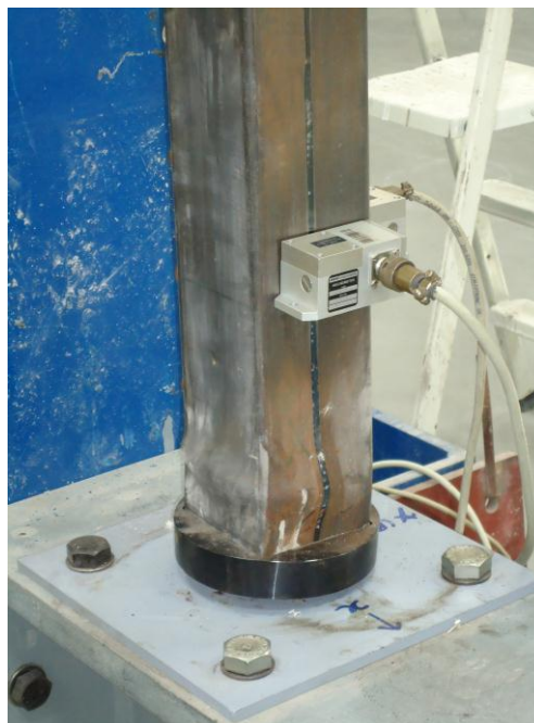
Fig.A1.2 – Coluna 1 depois do ensaio
