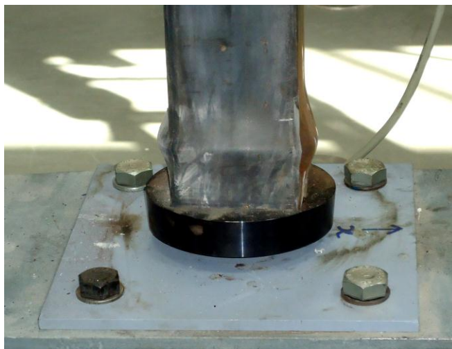
Fig.4.19 – 1ª coluna no final do ensaio
