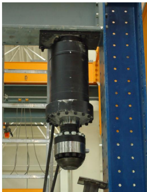
Fig.4.14 – Apoio superior - Atuador
