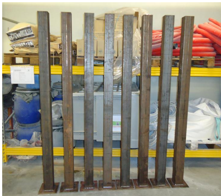
Fig.4.1 – Colunas antes da betonagem.
