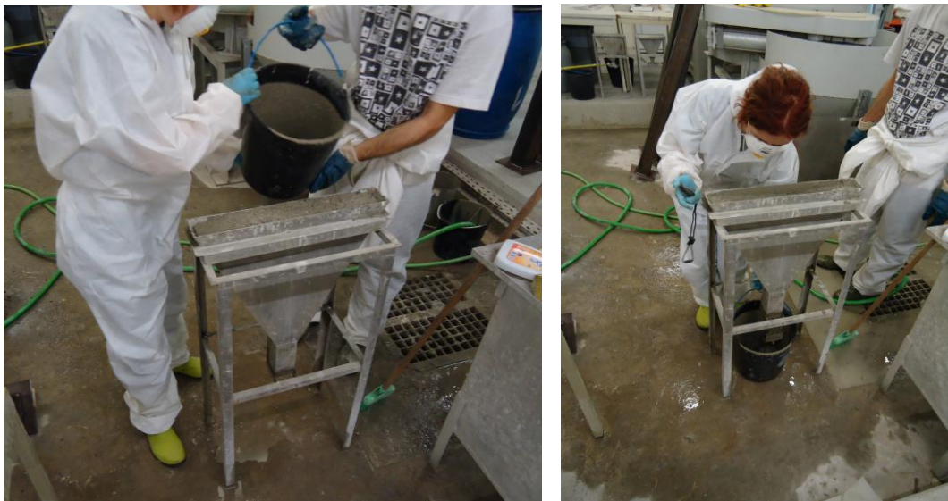
Fig.4.9 - Teste do funil em V - Esq.: Enchimento do funil com betão; Dir.: Cronometragem do tempo que o betão demora a passar pelo funil de acordo com [45]
