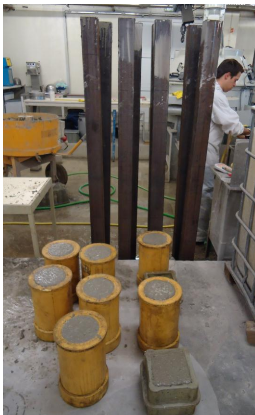
Fig.4.11 – Colunas após betonagem e provetes
