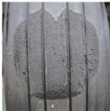
Fig. 2.5 - Deformação por desvulcanização (Goodyear (2003), adaptado por Rodrigues Filho (2006))
