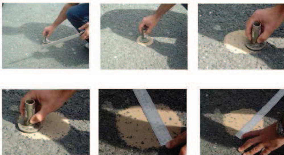
Fig. 2.19 - Sequência do ensaio da mancha de areia (Alves (2007), retirado de Soares (2011))
