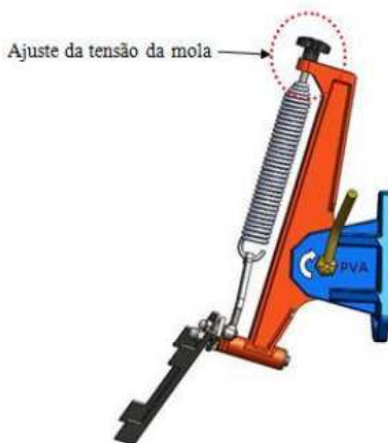
Figura 42 - Máquina de lançar pratos ajustável para o remate de hóquei em patins[4]
