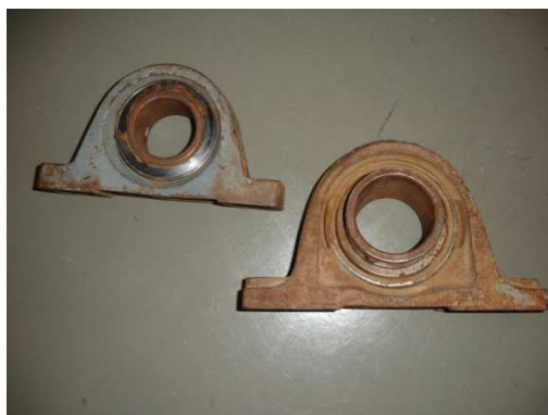
Figura 46 - Chumaceiras utilizadas no mecanismo para simular o remate
