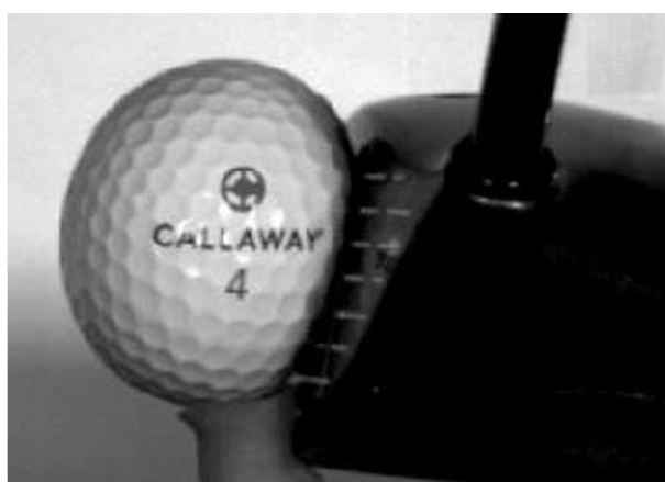
Figura 35 - Deformação da bola de golfe durante o impacto. [40]
