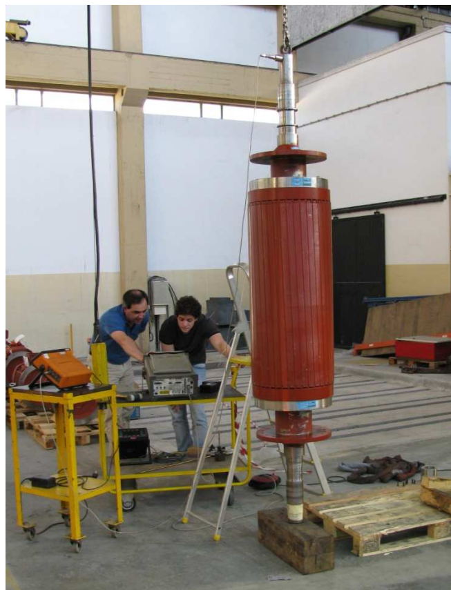
Figura 28: Ensaio de medição da curva de resposta em frequência.
