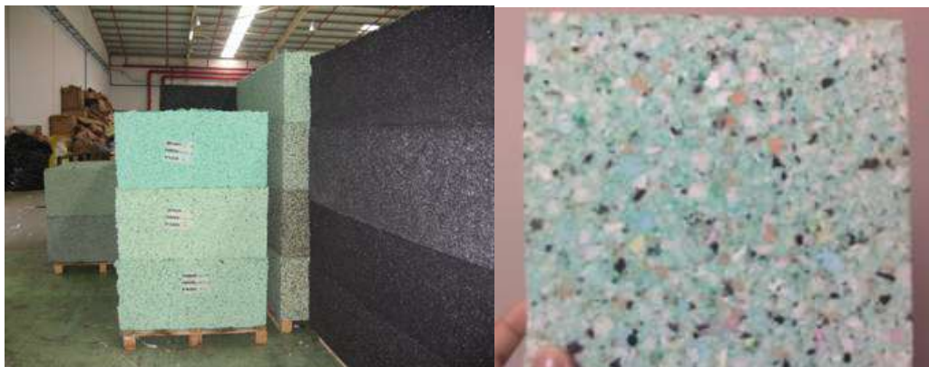
Figura 4.3 - Apeto espumas Aglomex Acoustic (adaptado de [3])
