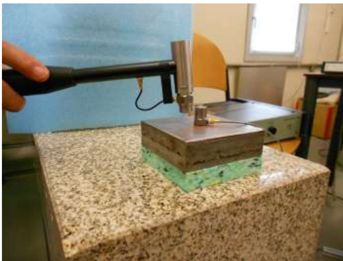
Figura 5.2 – Materialização do ensaio com a configuração de um grau de liberdade
