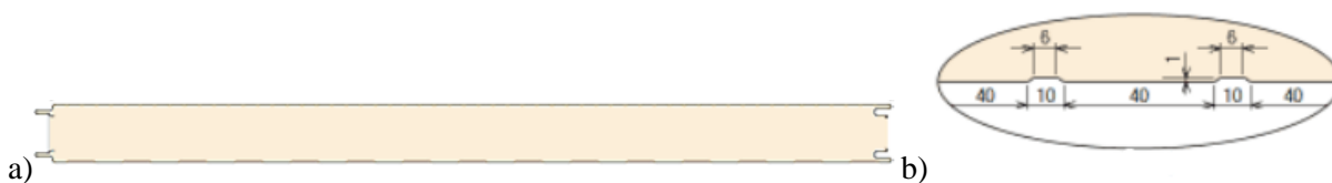
Fig. 4.10 – Painel composto tipo sandwich: a) Painel KS1150 TC b) Dimensões características da chapa interior [84].
