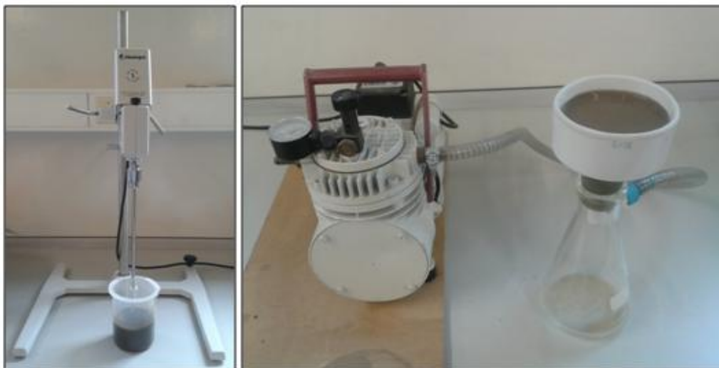
Figura 15. Lavagem do solo com co-solvente e filtração da mistura por vácuo.
