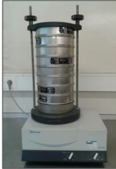
Figura 3. Equipamento usado na peneiração via seca - peneirador mecânico da marca Retsch, modelo AS 200 basic, e série de peneiros ASTM.
