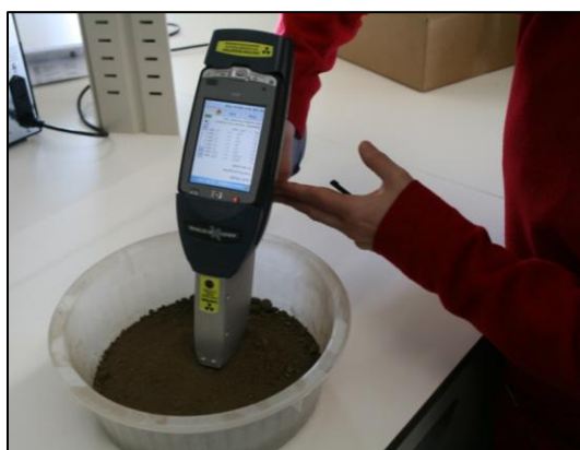
Figura 6. Medição da composição química de um solo com um analisador portátil de fluorescência por raio-X INNOV-X-SYSTEM, modelo \alpha -4000S (CIGAR 2007).
