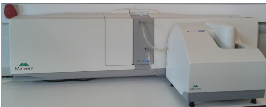
Figura 5. Granulómetro da marca Malvern, modelo Mastersizer 200 e módulo Hydro 2000 G.
