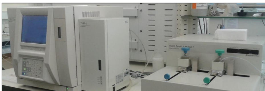
Figura 7. Analisador de Carbono Orgânico Total TOC-V CSH/CSN e módulo para amostras sólidas TOC-V Series SSM-5000A, da Shimadzu Corporation.
