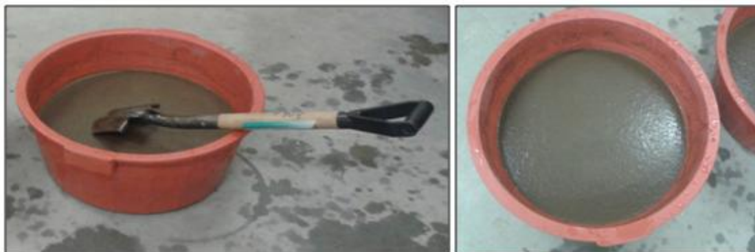
Figura 10. Fração do solo abaixo de 2,00 mm em solução com agente desfloculante.
