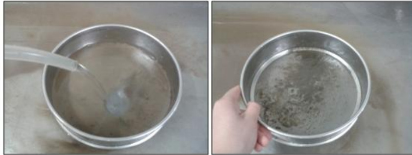
Figura 4. Peneiração por via húmida usando o peneiro de abertura 0,074 mm (200 mesh).
