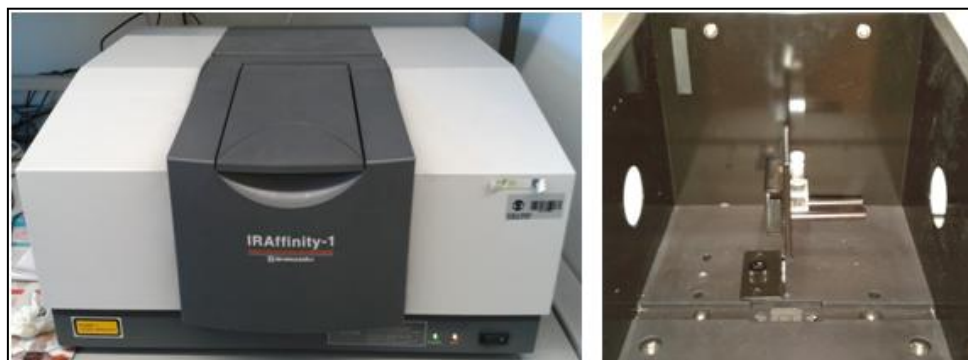
Figura 17. Equipamento FTIR da Shimadzu Corporation, modelo IRAffinity-1; interior do aparelho, célula com a amostra para análise.
