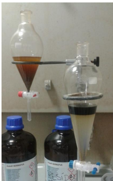
Figura 33. Extração líquido-líquido da solução obtida após lavagem do solo B com etanol e éter dietílico, respectivamente.
