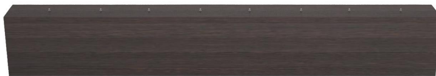
Figura 4.32 Colocação de chapa metálica na face inferior da seção, ligada por parafusos de porcas a toda a altura
