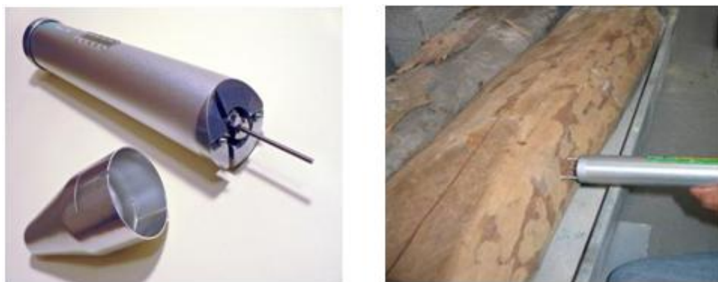
Figura 3.23 e 3.24 À esquerda, aparelho de ensaio Pylodin; À direita, exemplo de aplicação do Pylodin (Dias;2008)
