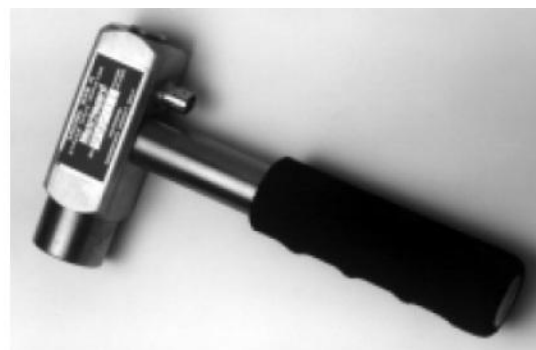
Figura 3.26 Unidade central e martelo de impacto - Metriguard (Junior;2006)
