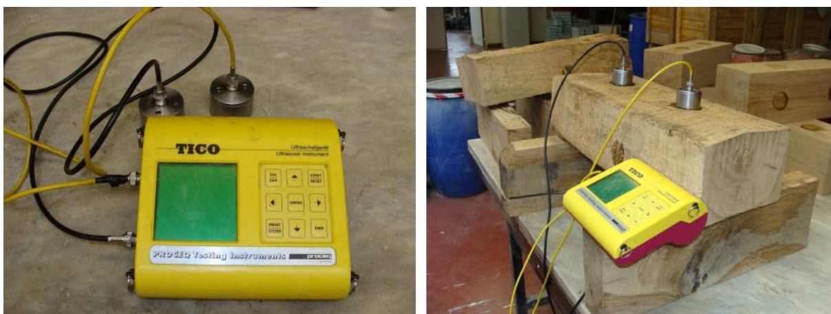
Figura 3.21 Equipamento de ensaios ultra-sons através do método de transmissão (Martins,2009)
