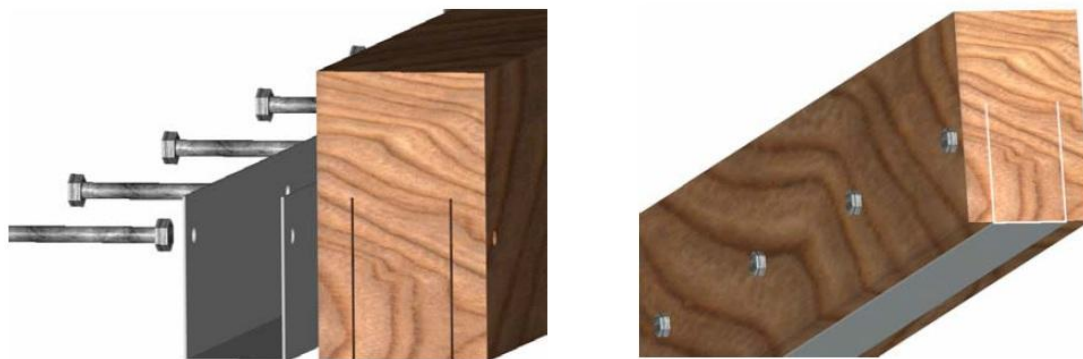
Figura 4.38 e 4.39 Exemplo de colocação de perfil “U” na face inferior da viga (França;2007)
