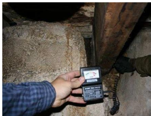
Figura 3.27 e 3.28 À esquerda, Exemplo do equipamento higrómetro (Martins;2009); À direita, aplicação de higrómetro em viga de pavimento (Guedes; Ilharco et al.;2012)
