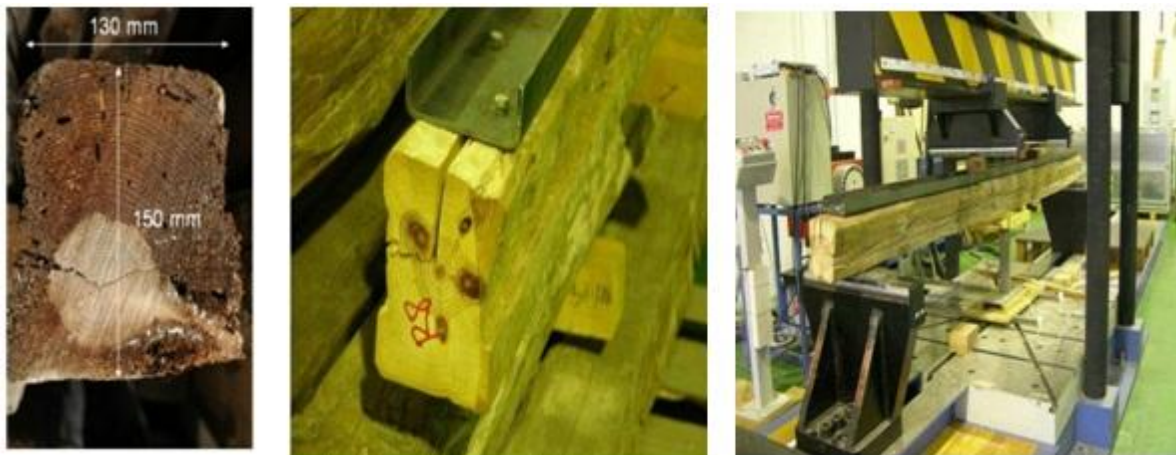
Figura 4.59, 4.60 e 4.61 À esquerda, exemplo de viga de madeira ensaiada (González-Bravo et al.;s/d); Ao centro, exemplo de viga de madeira com perfil metálico na face superior (González-Bravo;2007); À direita, ensaio de flexão da viga de madeira reforçada (González-Bravo;2007)
