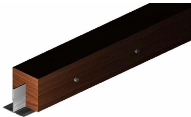
Figura 4.36 Pormenor de reforço através de "T" invertido na face inferior (França;2007)
