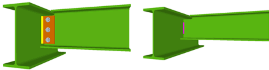
Fig 2.9 - Ligação aparafusada e soldada, respetivamente [14]
