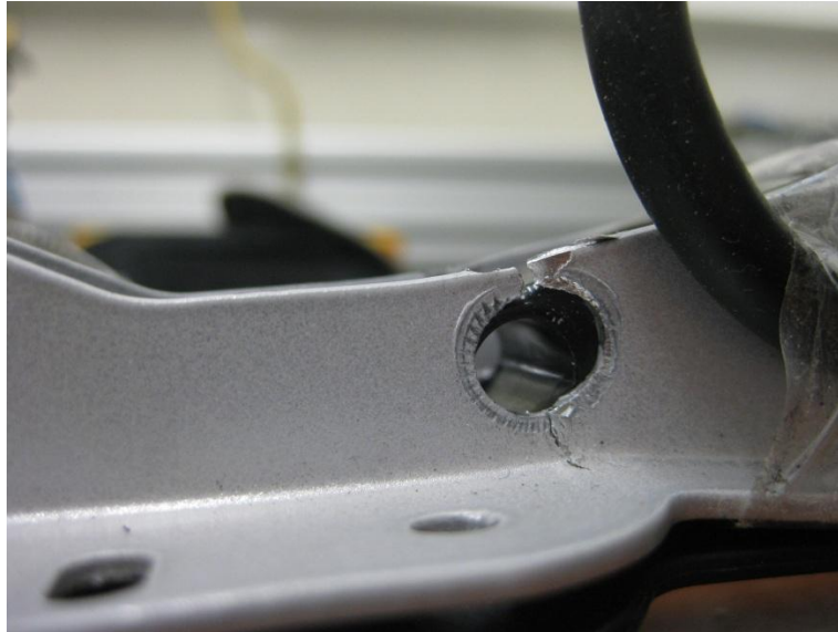
Figura 6.50 - Rotura localizada no patim
