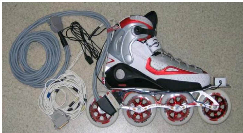
Figura 2.10 - Patim instrumentado para ensaio de telemetria [9].
