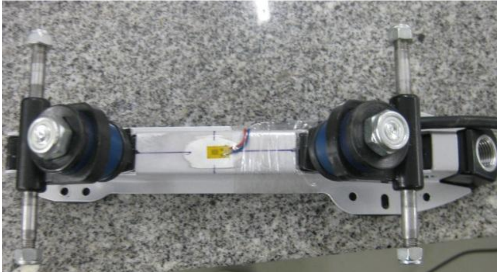
Figura 6.17 - Extensómetros colados no patim
