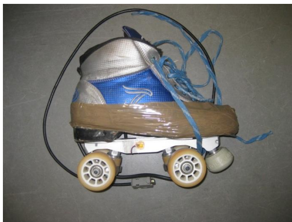
Figura 6.32 - Patim base em alumínio maquinado com sistema de telemetria
