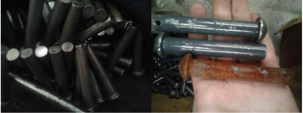
Figura 21 - Antes e depois da pintura dos pinos
