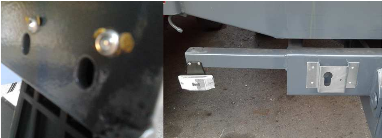
Figura 20 - Furação para colocação de farolins e suporte mangueiras
