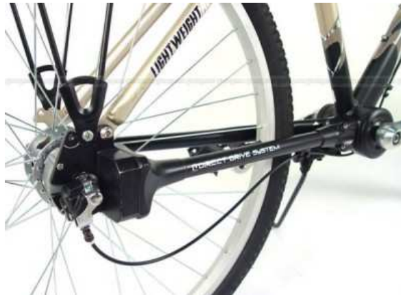
Figura 63. Transmissão por intermédio de um veio [50].
