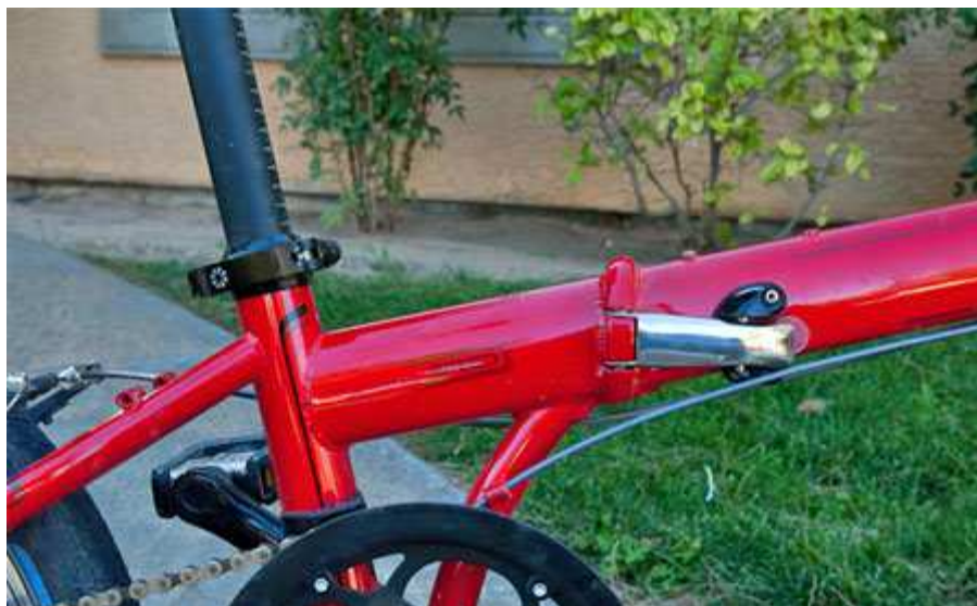
Figura 56. Pormenor da alavanca de bloqueio da bicicleta “Dahon” [44].
