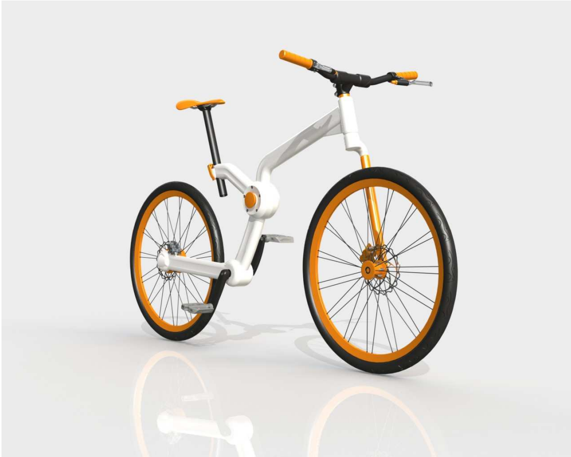
Figura 91. Bicicleta desdobrável “UrbanB”: sistema de mono-braços.
