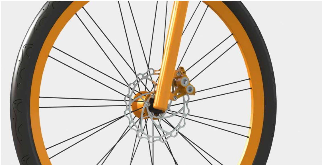
Figura 94. Bicicleta desdobrável “UrbanB”: Pormenor do travão de disco dianteiro.
