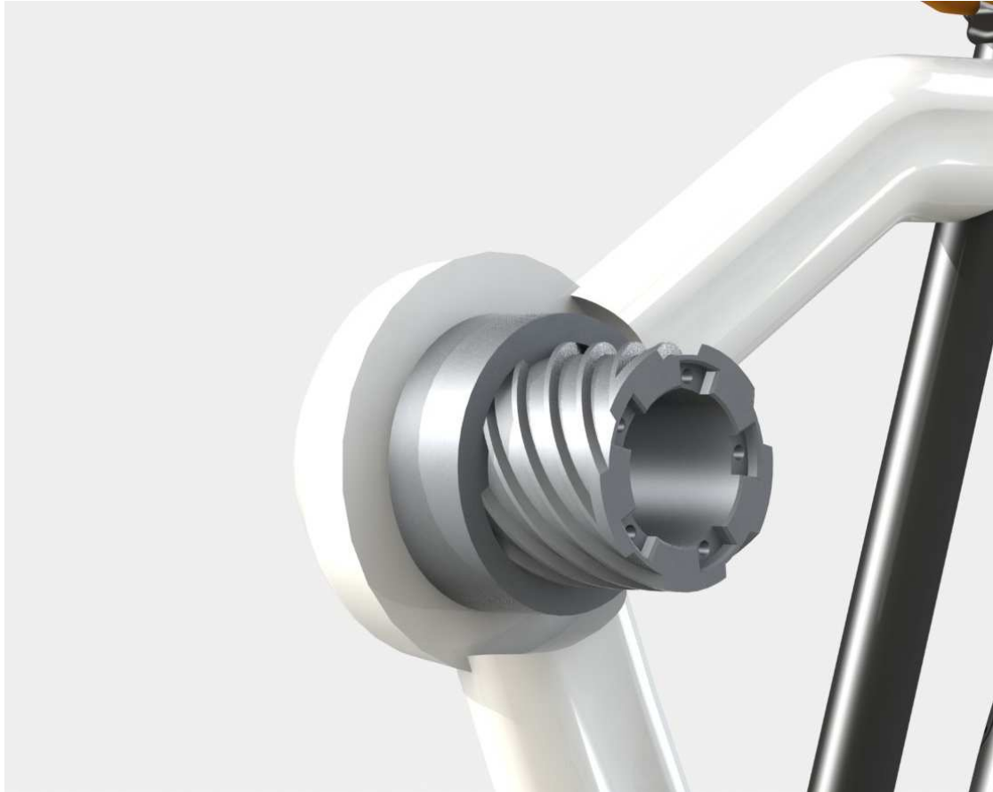
Figura 97. Bicicleta desdobrável “UrbanB”: Pormenor do sistema de rosca utilizado para o desdobramento.
