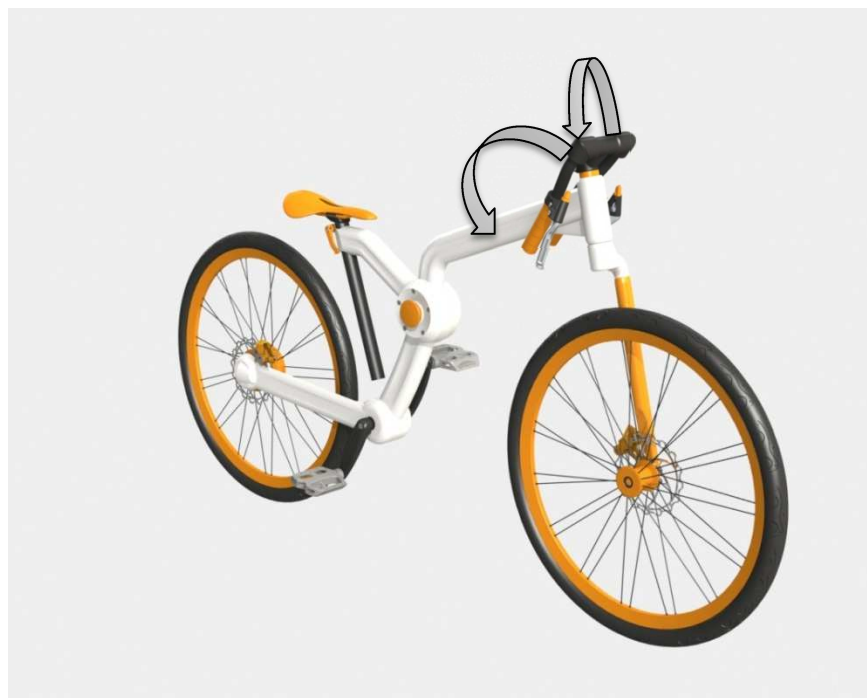
Figura 103. Bicicleta desdobrável “UrbanB”: Rebatimento do guiador.
