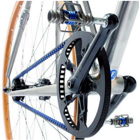
Figura 62. Transmissão por correia de borracha [49].
