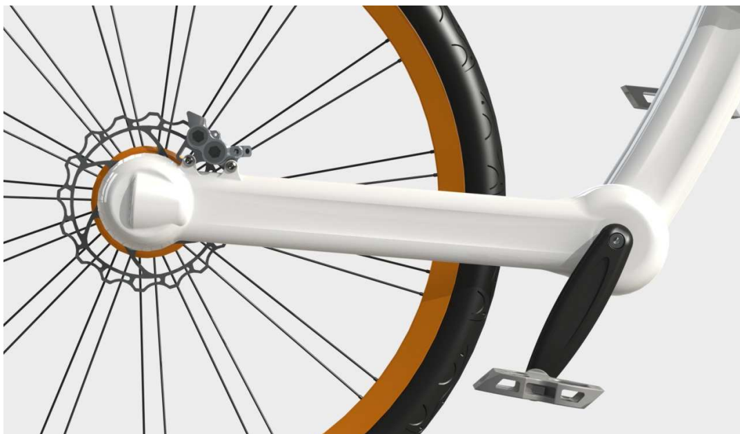
Figura 95. Bicicleta desdobrável “UrbanB”: Pormenor do alojamento do veio de transmissão para a roda traseira.
