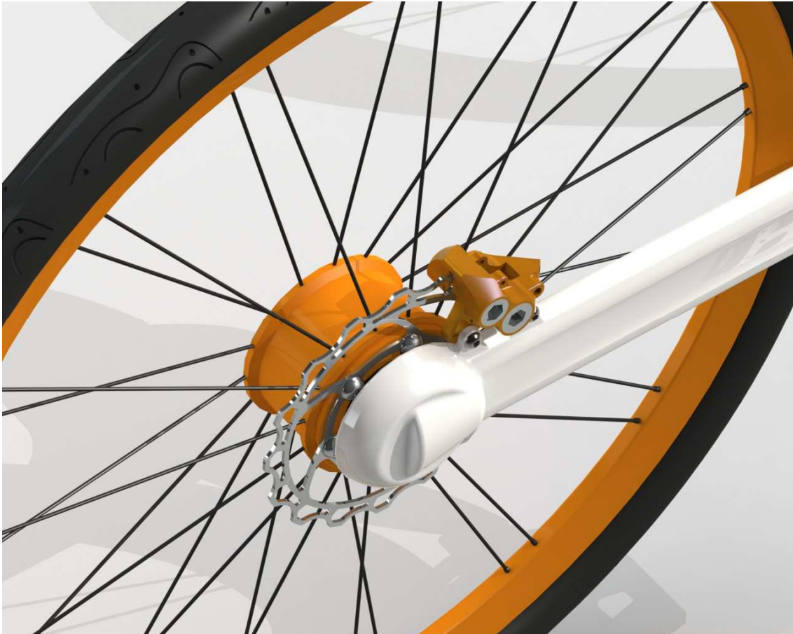
Figura 96. Bicicleta desdobrável “UrbanB”: Pormenor do cubo traseiro onde se encontra o sistema de velocidades.
