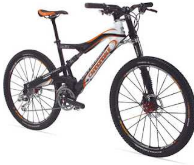
Figura 92. Bicicleta Cannondale Lefty com sistema mono-braço [52].
