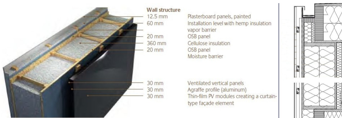
Fig. 4.19 – Constituição da Parede Exterior [84].
