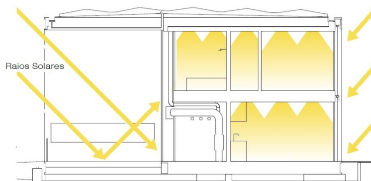
Fig. 4.33 – Esquema de Iluminação prevista na EHPE [84].
