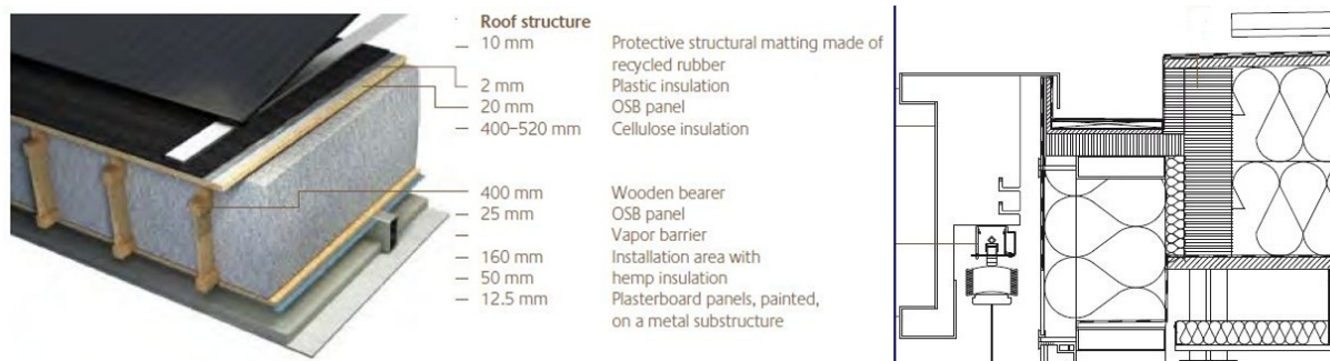
Fig. 4.16 – Constituição da Cobertura [84].
