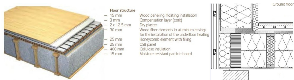
Fig. 4.18 – Constituição da Laje do Piso Térreo [84].
