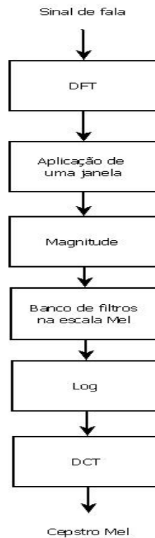
Figura 2.4: Computação dos coeficientes MFCC
