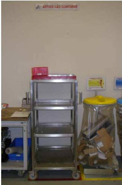
Figura 28- Implementação de Zona de artigos não conformes
