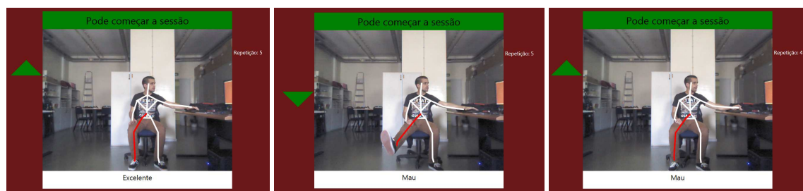
Figura 4.13: Janela para realização da reabilitação. A sequência de imagens é representativa da sequência de realização do exercício de extensão/flexão do joelho em posição sentado
