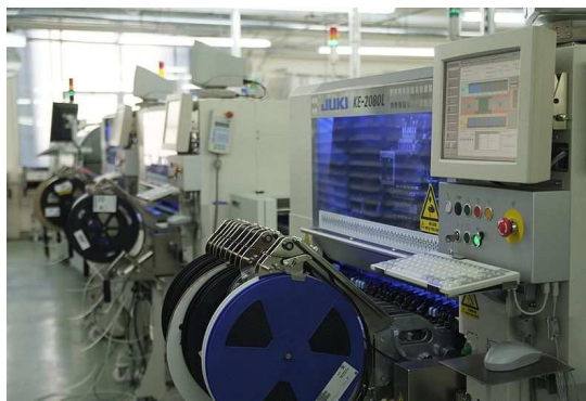
Ilustração 8 – Linha de inserção automática
