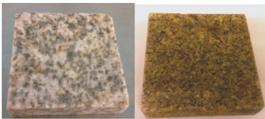
Figura 34 - Amostra antes e depois de submetida à solução de HCl
