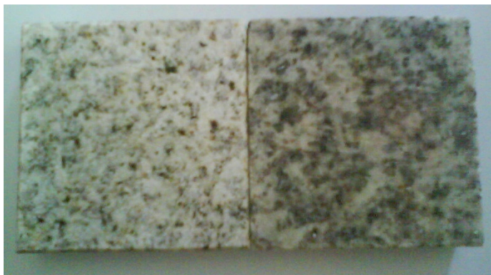
Figura 35 - Amostra antes e depois de submetida à solução de H_2SO_4
