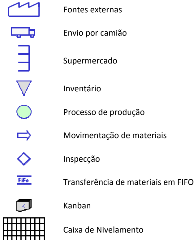
Figura 8 - Símbolos utilizados no Value Stream Mapping
