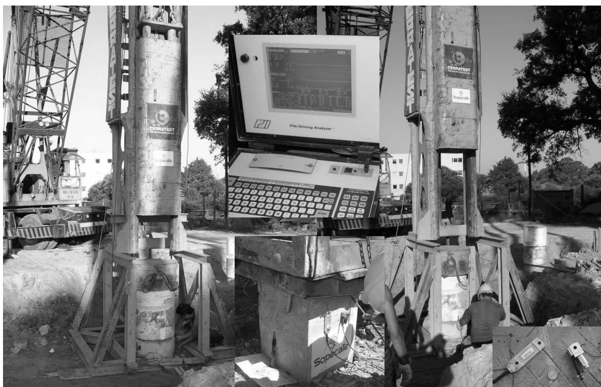
Figura 33. Ensaios estáticos e dinâmicos em estacas no Campo Experimental da FEUP (ISC'2).
