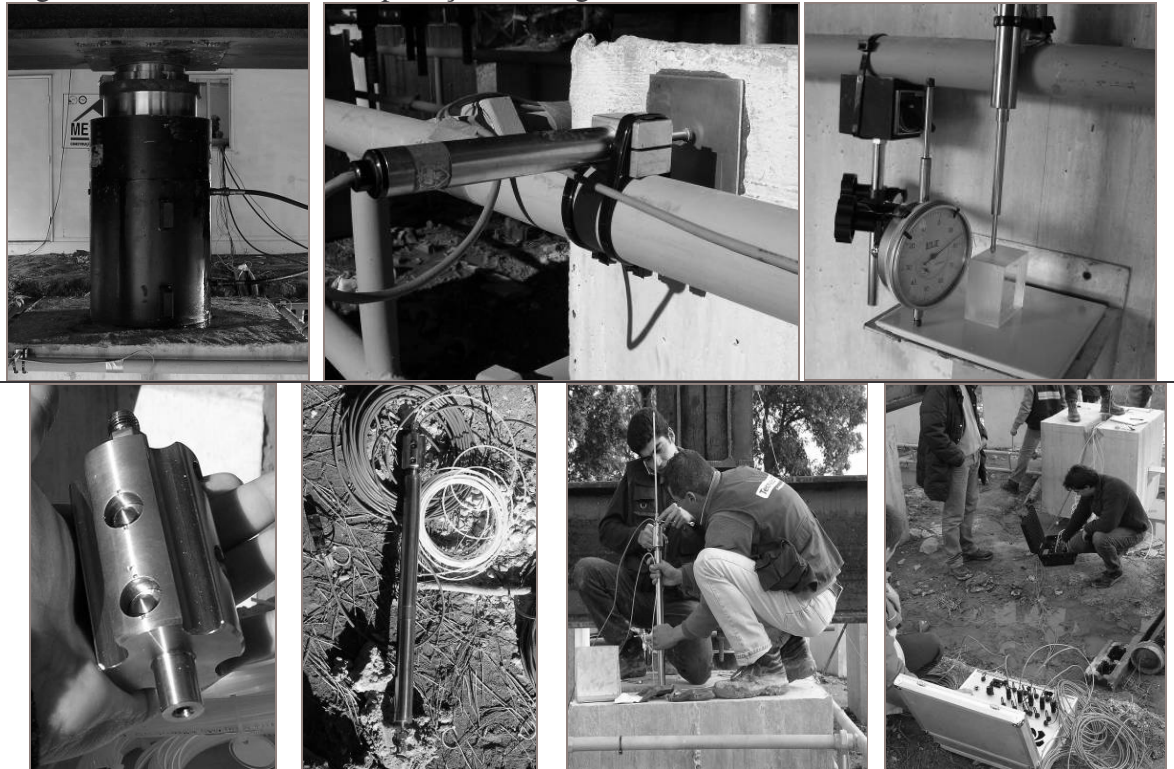
Figura 10. Sistema de aplicação e controlo da carga; instrumentação externa (transdutores de deslocamento) e interna (sensores; no interior do tubo de PVC e datalogger (Tecnasol-FGE, SA).
