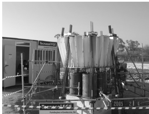
Figura 20. Ensaio de carga vertical - IP6 Viadutos na ligação Peniche-A8 (Tecnasol FGE)
