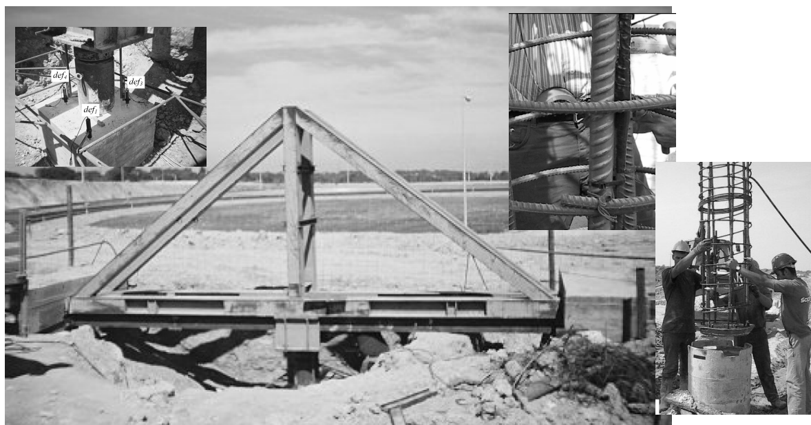
Figura 25. Vista geral e pormenores da instrumentação do ensaio estático com a estrutura de reacção – Santo Estevão (Gouveia Pereira, 2003).
