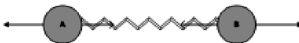
Figura 15 - Comportamento repulsivo de duas partículas de carga eléctrica ligadas através de uma mola [9]
