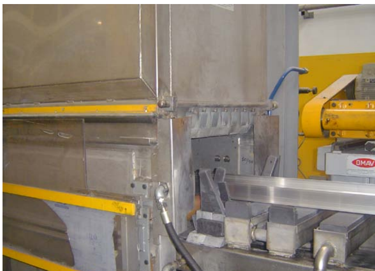
Figura 9 - Fotografia de um perfil a entrar no túnel de arrefecimento
