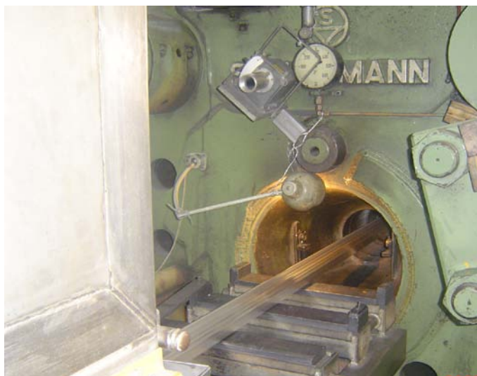
Figura 8 - Fotografia do extrudido à saída da prensa. É possível ver a curta distância entre esta e o túnel de arrefecimento (à esquerda na imagem).
