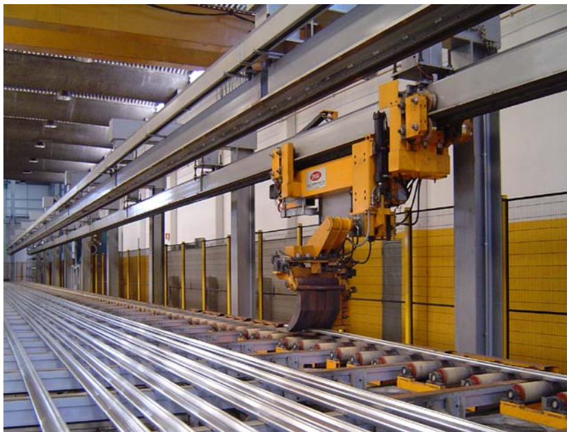
Figura 10 - Fotografia de um perfil acabado de extrudir a ser puxado pelo "puller" ao longo da pista de extrusão. Esta pista tem por baixo ventiladores que permitem arrefecer o perfil. Os outros perfis visíveis na imagem estão na pista onde serão sujeitos ao esticamento.
