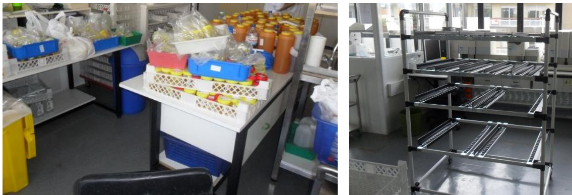
Figura 26 – Estante dinâmica desenhada com movimentação gravítica de tabuleiros através de rolos que evita situações como tabuleiros sobrepostos e desorganizados.
