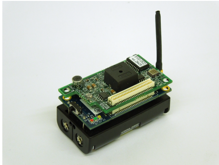
Figura 4.3: O mote IRIS da Memsic, com o módulo de sensores MTS310CB acoplado.
