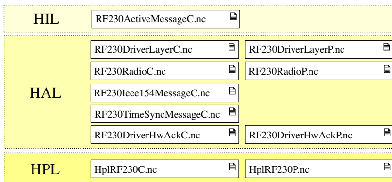
Figura 4.1: Exemplo da Arquitetura de Abstração do módulo AT86RF230 no TinyOS
