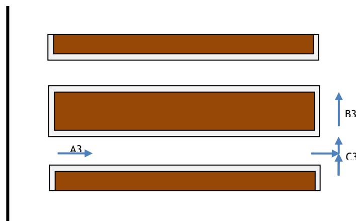
Figura 27 - Zonas de transporte de energia por convecção: A3 - canais radiais; B3 - canais axiais; C3 - confluência de caudais
