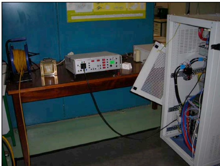
Figura 5.15 - Teste de imunidade a sobretensão (surge) segundo a norma EN 61000-4-5.
