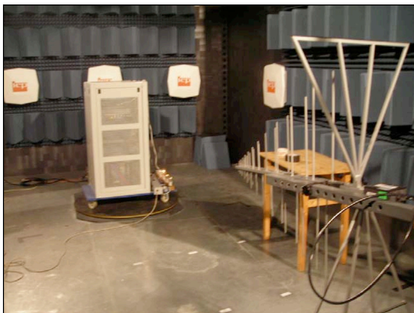
Figura 5.24 - Ensaio de Emissão Radiada
