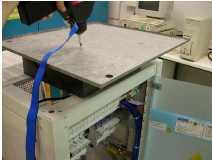
Figura 5.7 - Teste de descarga electrostática indirecta horizontal.
