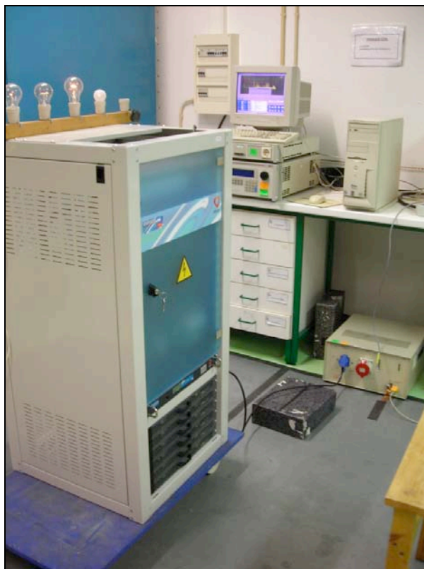
Figura 5.21 - Ensaio de Emissão Conduzida - Perturbações de Radiofrequência segunda EN 55022
