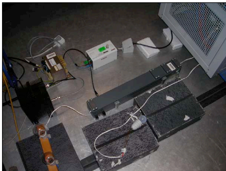
Figura 5.17 - Teste de imunidade a perturbações conduzidas, induzidas por campos de radiofrequência segundo a EN 61000-4-6
