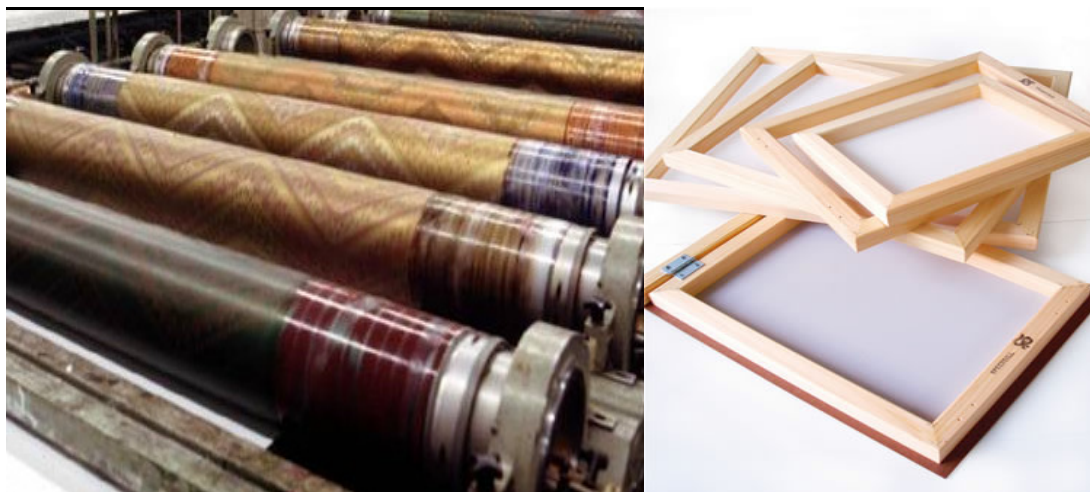
Figura 2.2 Representação de quadros rotativos (esquerda) e quadros planos (direita). [6,7]
