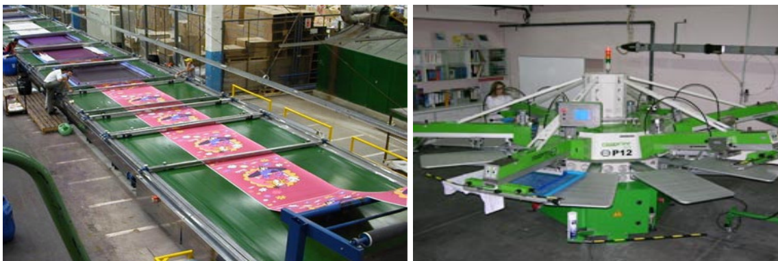
Figura 2.4 Representação de quadro plano contínuo (esquerda) e quadro plano descontínuo (direita). [10,11]
