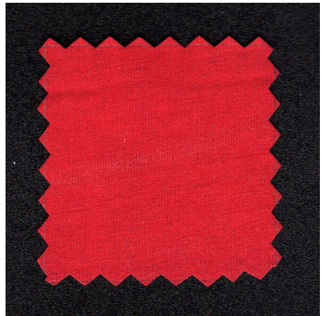
Figura 3.14 Amostra do estampado do Ensaio 8 - 3ª Lavagem
