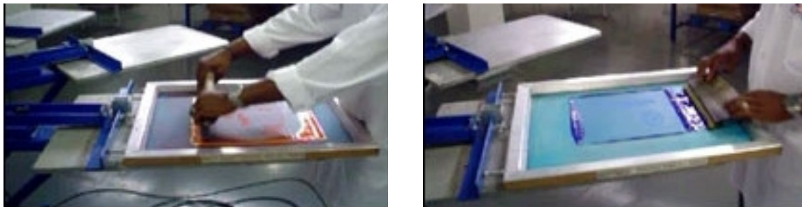
Figura 3.1 Representação da forma como se realiza o método de estampagem [21]
