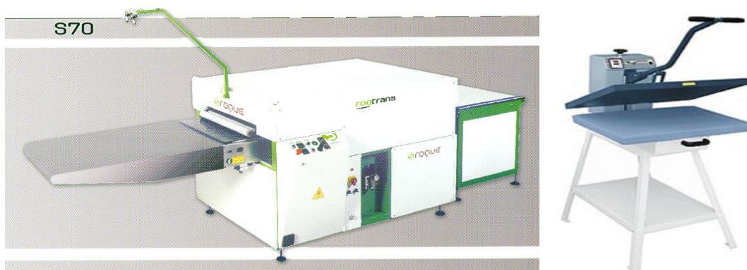
Figura 2.5 Representação de prensa contínua (esquerda) e prensa descontínua (direita). [11,12]
