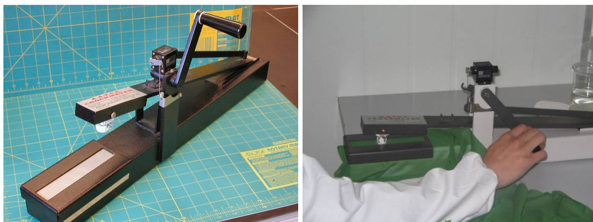
Figura A4.1 Imagem do equipamento Crockmeter [25,26]
