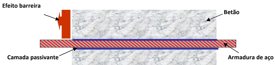
Figura 1 – Esquema de betão armado (adaptado de [2])
