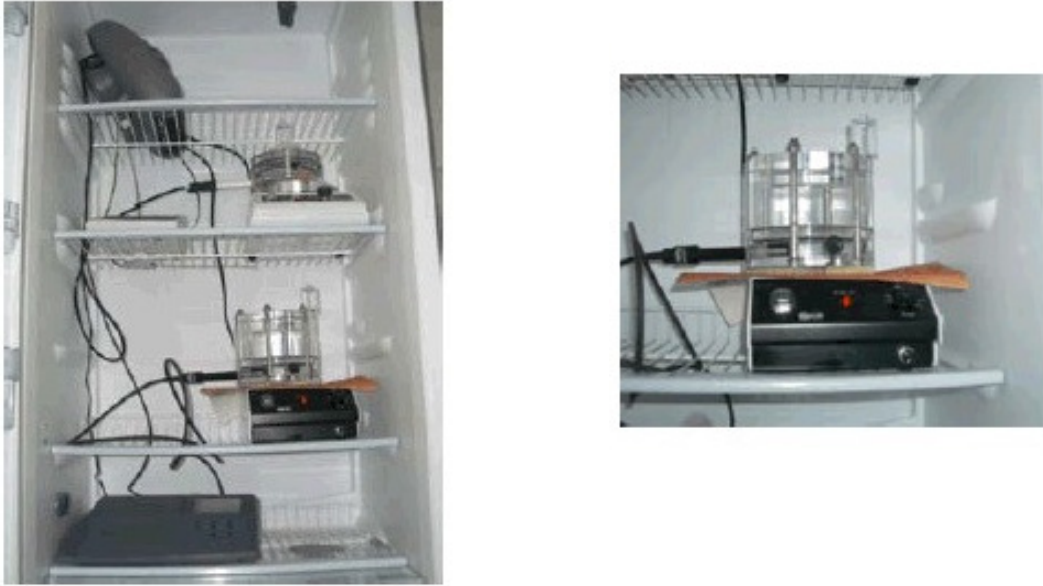
Figura 9 – Unidade de determinação de permeabilidade aos cloretos.
