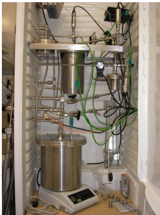
Figura 6 – Instalação experimental utilizada para medir a permeabilidade de gases.
