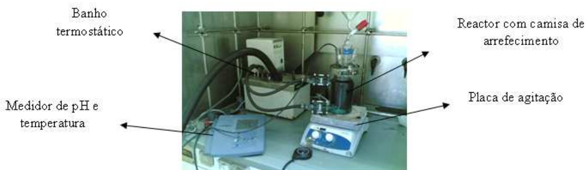
Figura 7 Instalação laboratorial de síntese de polianilina.
