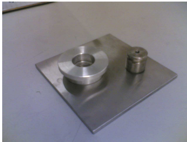
Figura 9 Molde usado para a preparação das pastilhas prensadas de PANI.
