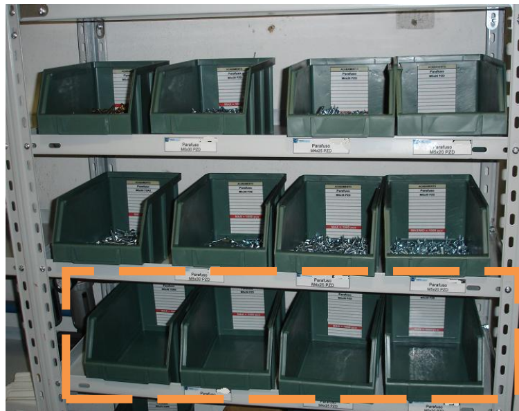
Figura 36 - Montagem Inicial de Supermercado da Zona Acabamento
