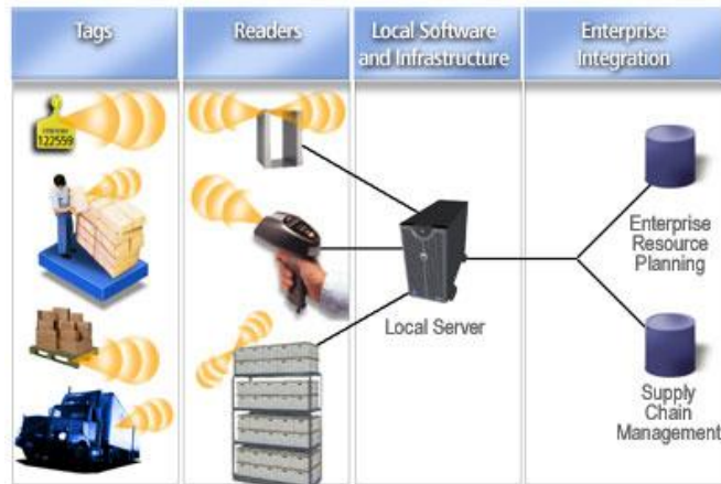
Figura 2 – Sistema RFID fonte: http://www.12manage.com/images/picture_rfid_technology.jpg
