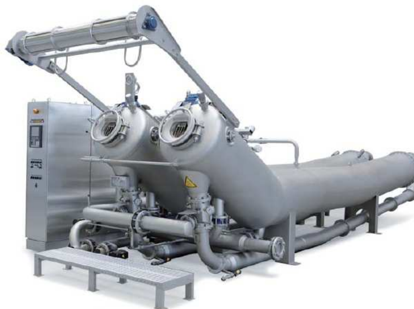
Figura 2.7 - Máquina para tingimento descontínuo do tipo Jet - a tela circula internamente sob a forma de corda durante a execução do processo de tingimento.
