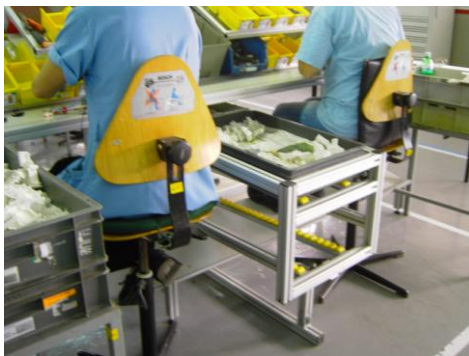
Figura 91_solução adoptada para eliminar os cavaletes e implementar o two Bin system
