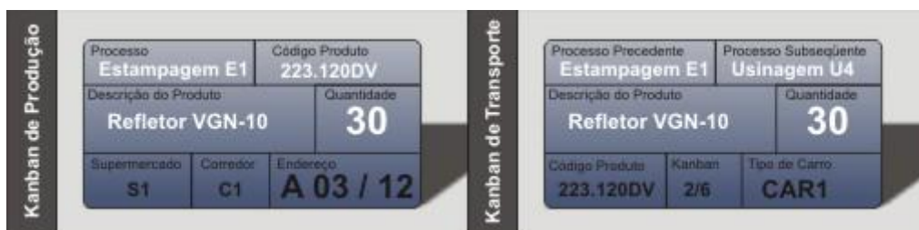
Figura 8_ Exemplo de um kanban de produção e de transporte.
