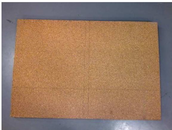
Figura 169- Bloco de cortiça com marcação das placas
