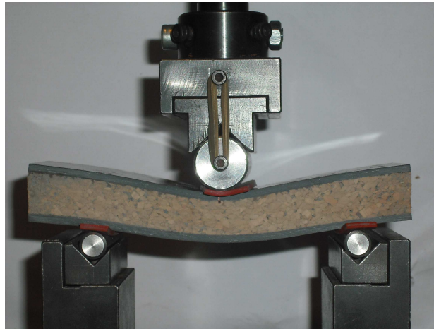
Figura 224- Flexão em 3 pontos da estrutura sandwich de aglomerado de cortiça sem furos
