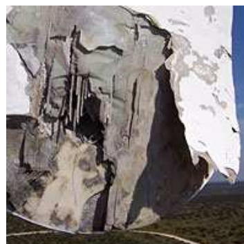
Figura 49- Dano provocado pela trovoadas [2.24]
