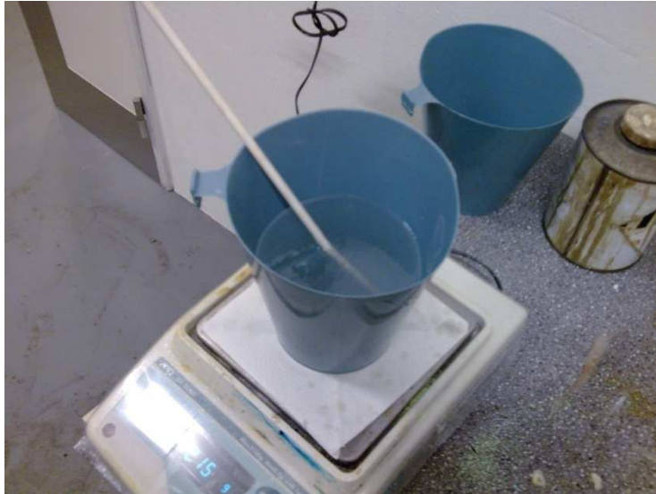
Figura 181- Preparação da resina a utilizar na infusão por vácuo
