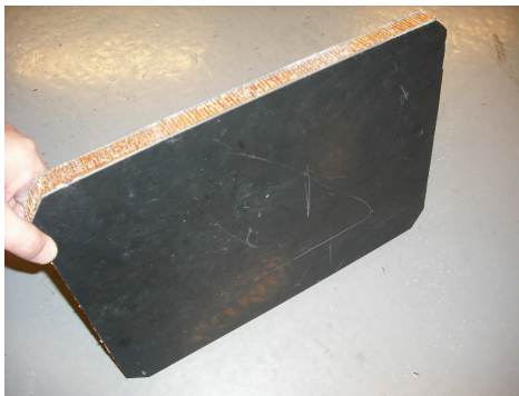
Figura 190- À esquerda a estrutura sandwich com Nomex® e à direita com aglomerado de cortiça sem furos
