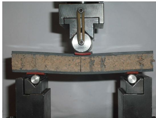
Figura 227- Flexão em 3 pontos da estrutura sandwich de aglomerado de cortiça e furos em linha
