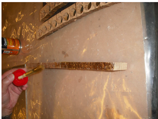
Figura 178- Colagem dos vários pedaços de cortiça virgem
