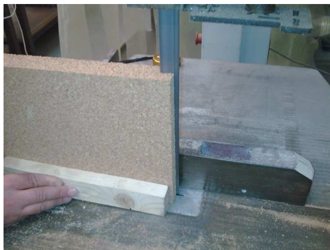
Figura 170- Corte do aglomerado de cortiça para ter 16mm de espessura
