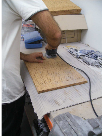
Figura 176- Uniformização das superfícies
