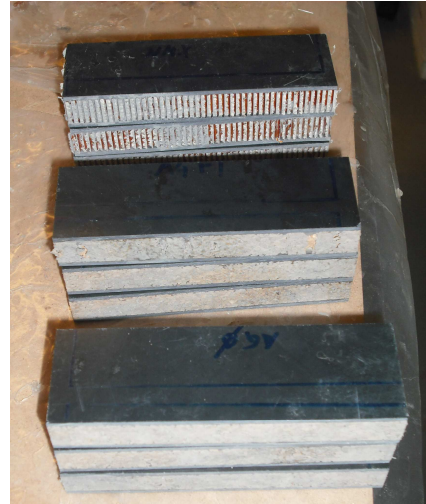
Figura 191- Alguns provetes para flexão
