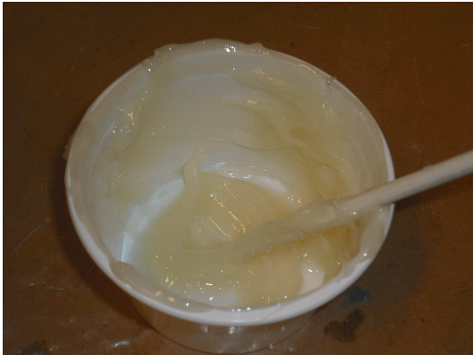
Figura 188 – À esquerda tem-se a mistura de resina com endurecedor e à direita a resina espalhada numa pele da sandwich
