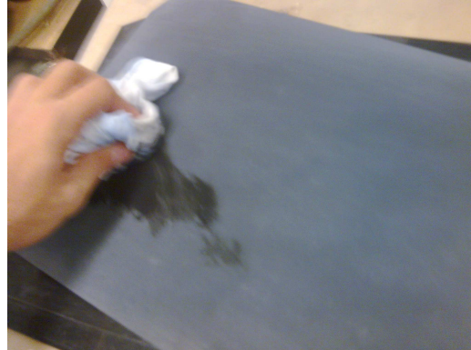
Figura 186 – Limpeza da superfície com isopropanol
