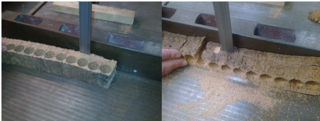
Figura 172- Corte da cortiça virgem com furos das rolhas
