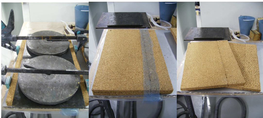
Figura 175- Processo de ligação dos núcleos com cola de contacto
