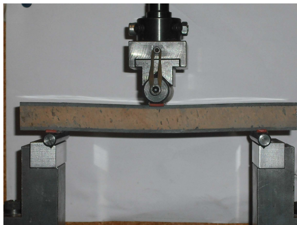
Figura 232- Flexão em 3 pontos da estrutura sandwich de cortiça virgem
