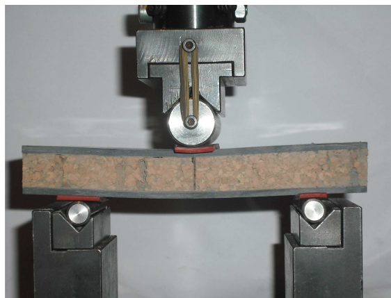
Figura 229- Flexão em 3 pontos da estrutura sandwich de aglomerado de cortiça e furos em triângulo
