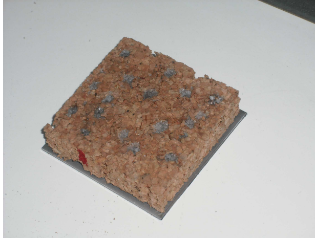
Figura 195- Núcleo de cortiça com furação em triângulo com gel de Poliacrilato de Sódio nos furos
