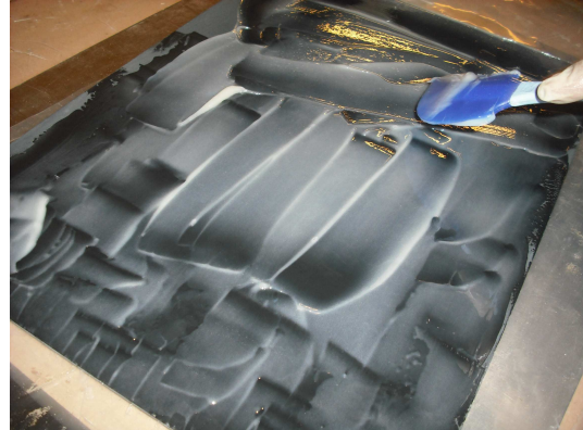
Figura 188 – À esquerda tem-se a mistura de resina com endurecedor e à direita a resina espalhada numa pele da sandwich
