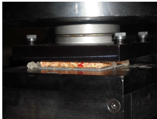
Figura 219- Saída de gel do interior do núcleo
