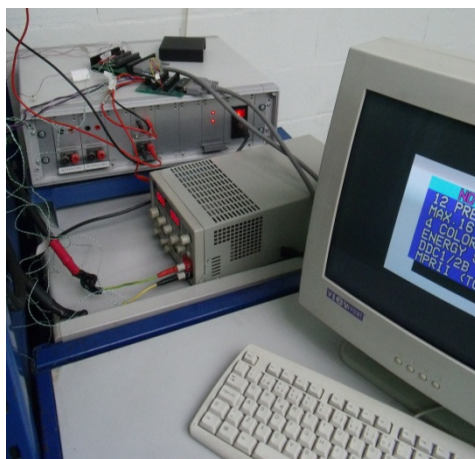
Figura IV.7 - Fotografia do sistema de medição e controlo da célula de combustível e sistema de aquisição de dados.
