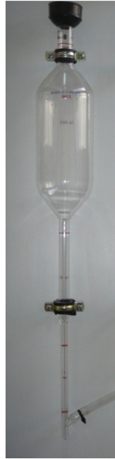
Figura B.4 - Medidor de bolha de sabão utilizado na calibração do rotâmetro de hidrogénio.
