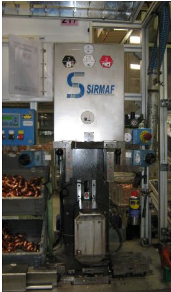
Figura 20 - Local onde são montadas as serpentinas, cotovelos e fusíveis na saia.
