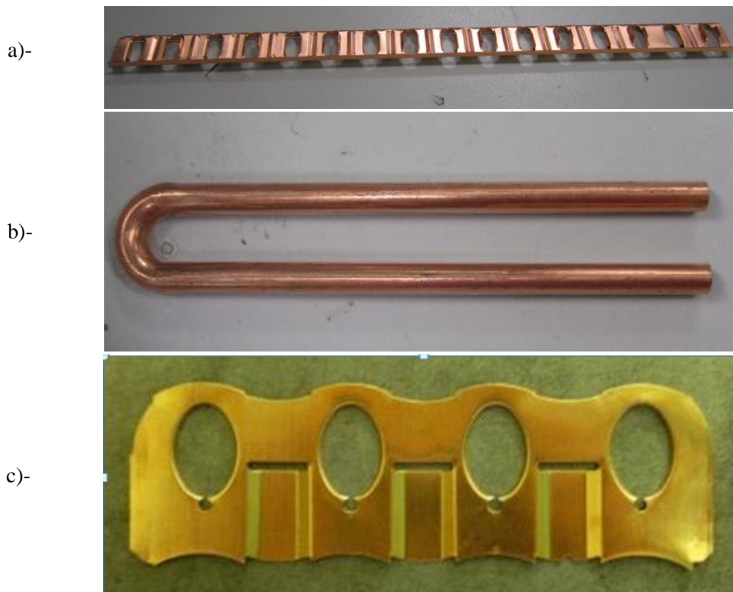
Figura 4 – Conjunto de componentes que formam o bloco de lamelas: a)- turbulador; b)- tubo em “U”; c)- lamela.
