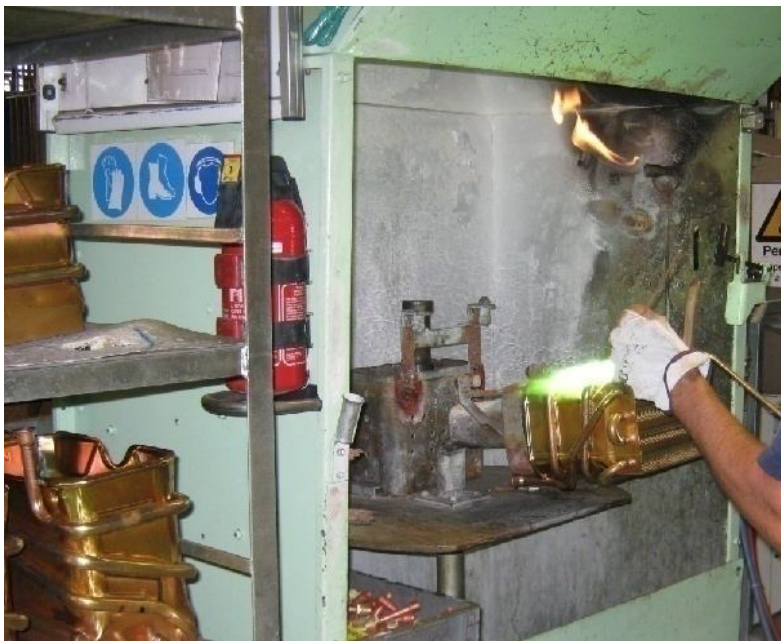
Figura 24 – Execução de trabalhos de recuperação de câmaras de combustão com defeitos de brasagem numa cabine de soldadura.
