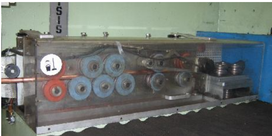
Figura 35 – Rolos de tracção da máquina de dobrar serpentinas que necessitaram de ser substituídos.
