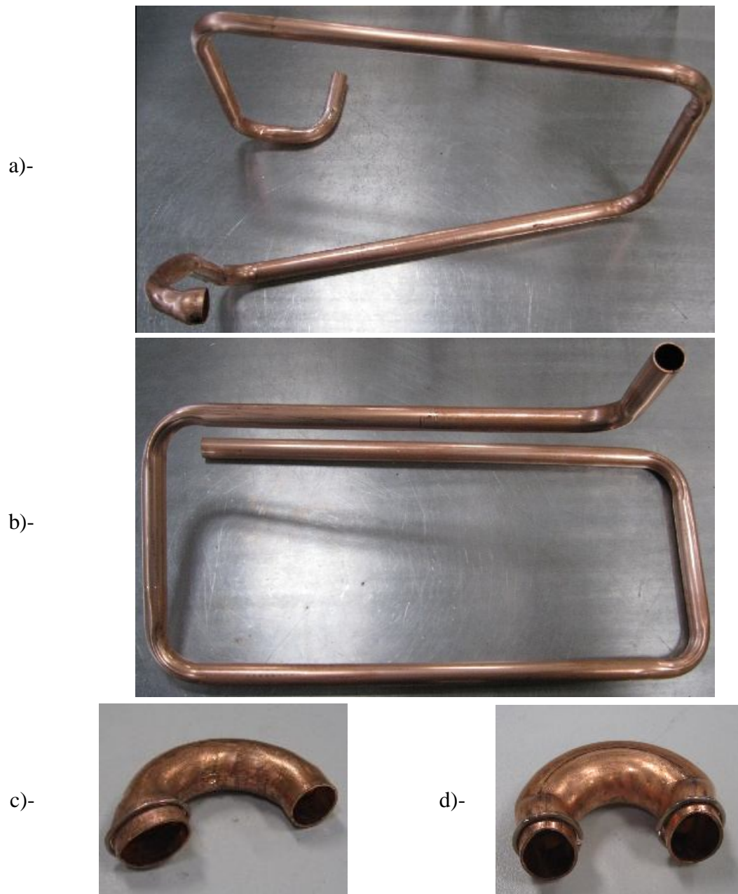
Figura 6 – a)- serpentina de água fria; b)- serpentina de água quente; c)- cotovelo; d)- fusível.
