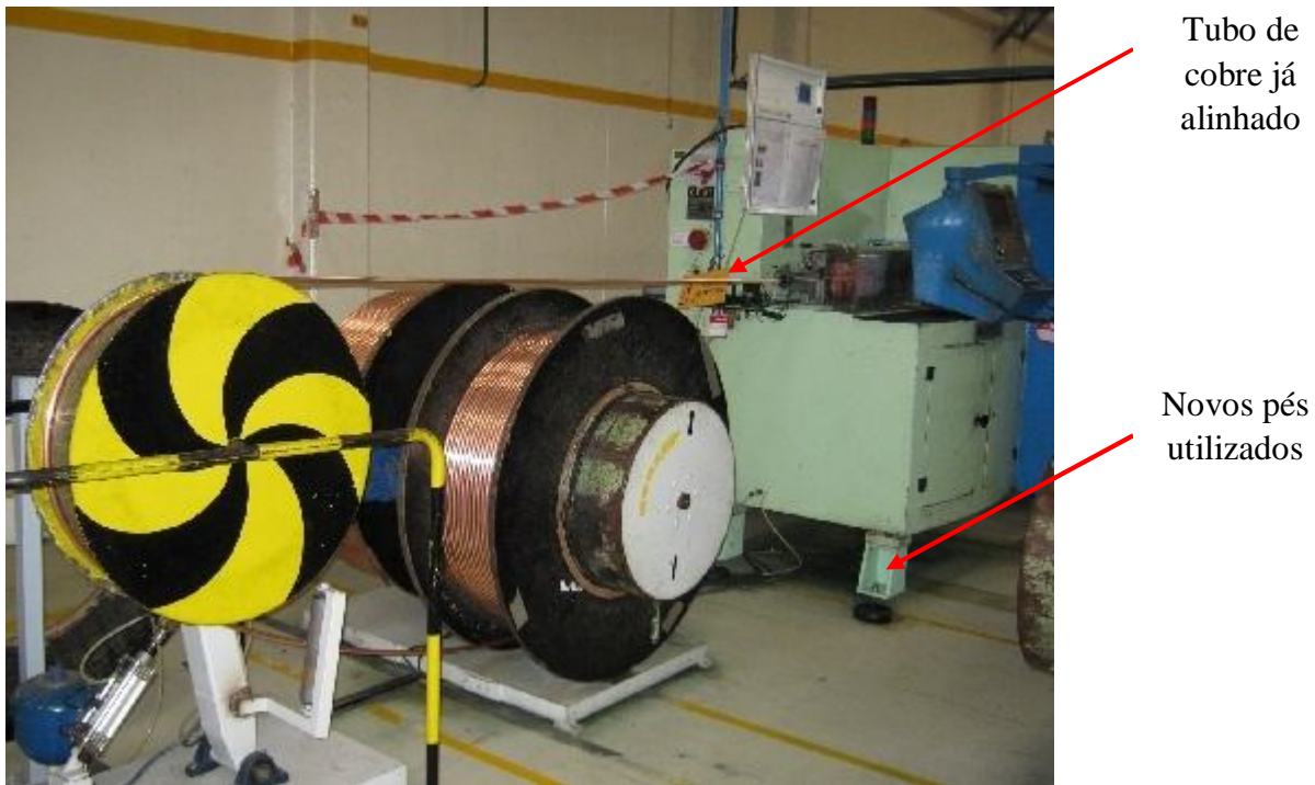
Figura 34 – Novo alinhamento do tubo na máquina de dobragem de serpentinas.
