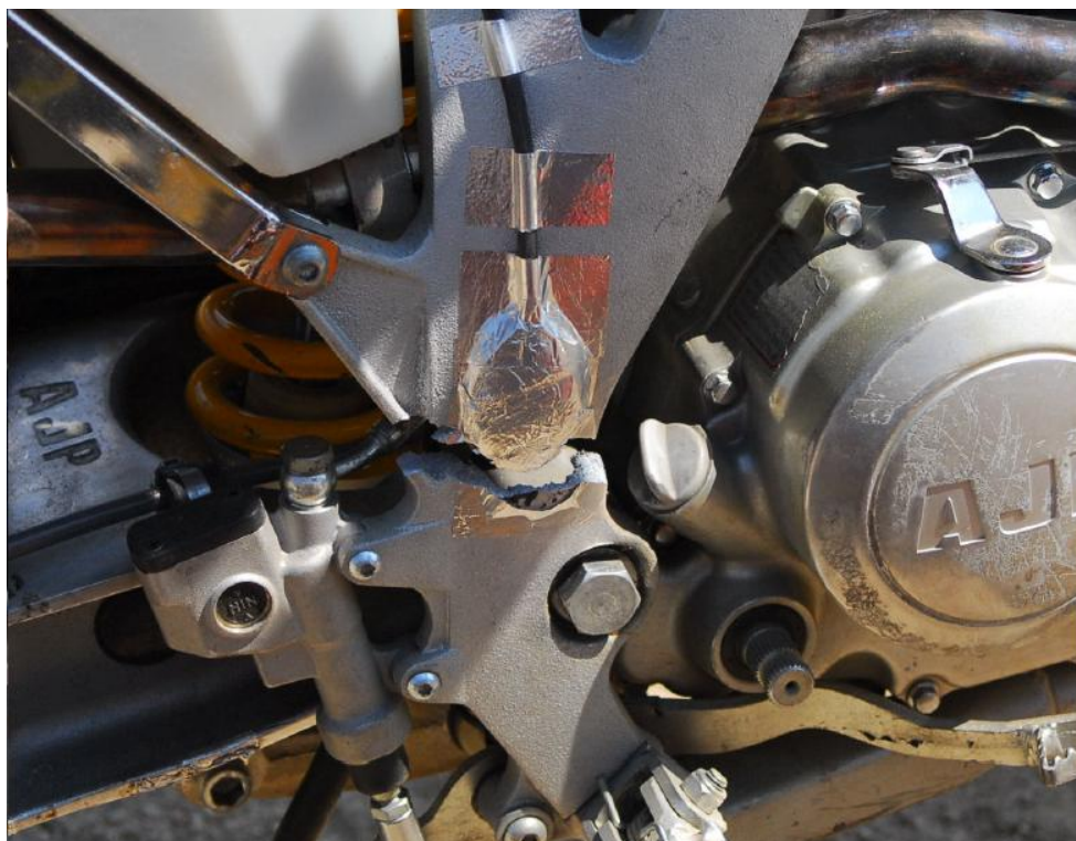
Fig. 159 – Rotura na trave do lado direito
