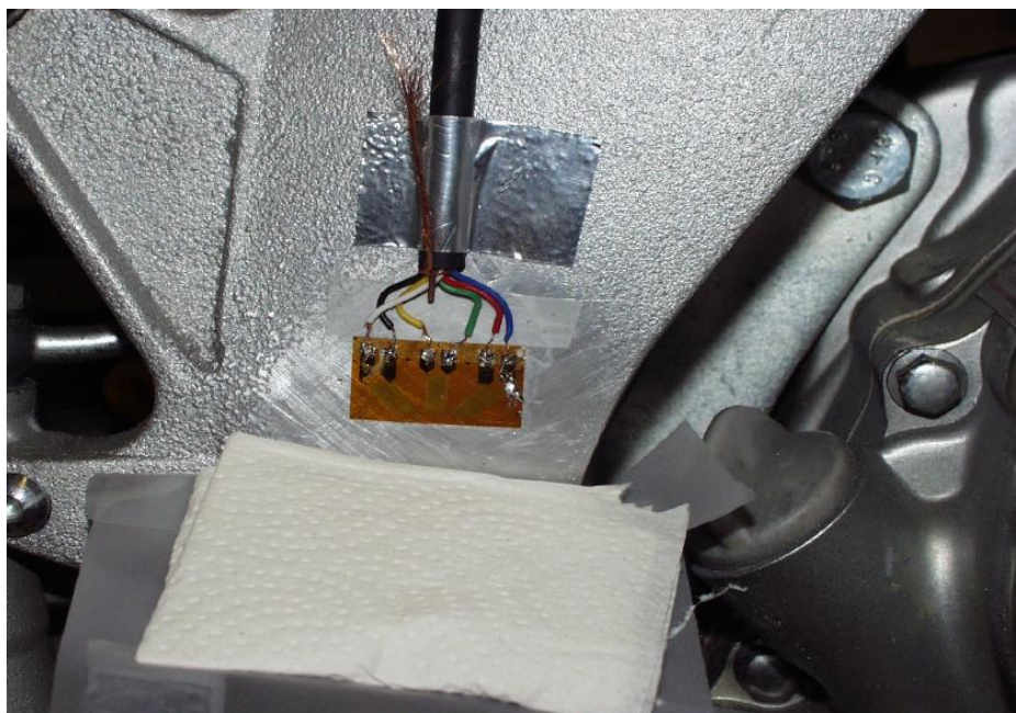
Fig. 157 - Colocação de roseta na trave direita
