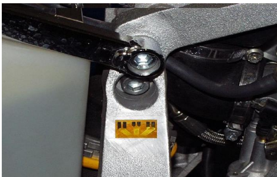
Fig. 158 - Colocação de roseta próximo da fixação superior do amortecedor
