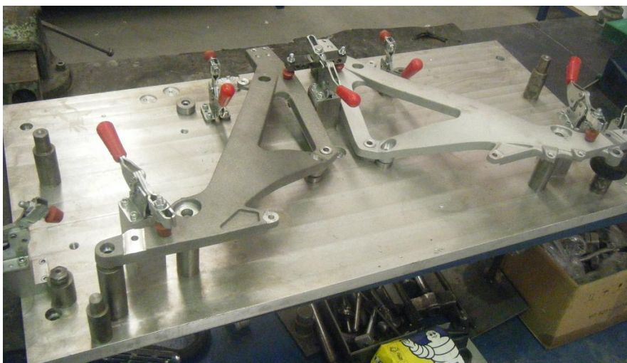
Fig. 118 - Gabari construído para maquinagem das traves
