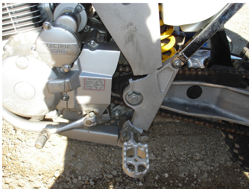
Fig. 156 – Rotura na trave do lado esquerdo
