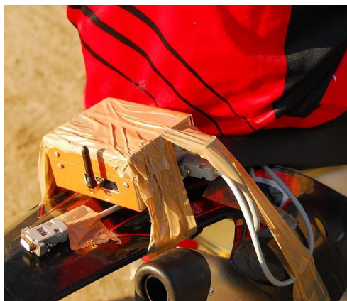
Fig. 147 – Sistema de telemetria aplicado na traseira
