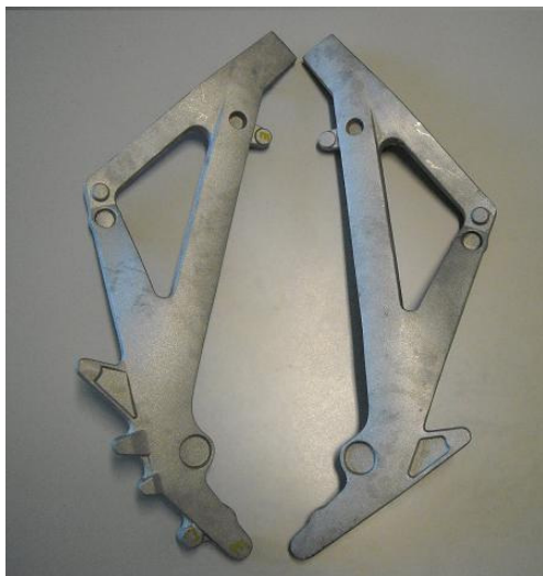
Fig. 116 – Traves da PR3 em bruto - exterior
