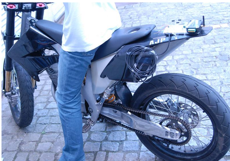
Fig. 145 – PR3 equipada com o sistema de telemetria.
