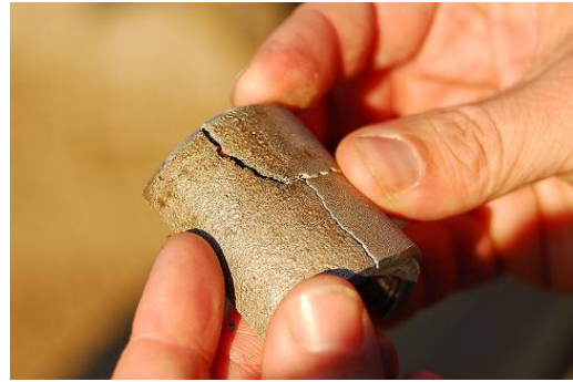
Fig. 152 - Rotura da biela do braço
