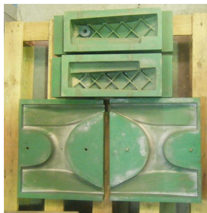
Fig. 94 - Caixas de machos do braço da PROTO 400
