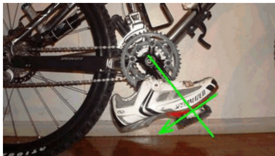
Figura 21 demonstração dos ângulos formados pela sapatilha ao peixo do pedal e ao solo, fonte http://2.bp.blogspot.com
