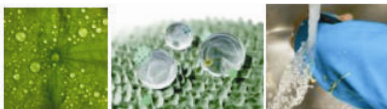
Figura 28-a, folha do Lotus com gotas de água, figura 28-b representação da estrutura da folha e seu mecanismo para auto limpeza, ao cair a água as gotas arrastam toda a sujidade suspensa e sua superfície figura 28-c tecido schoeller Nanosphere®.
