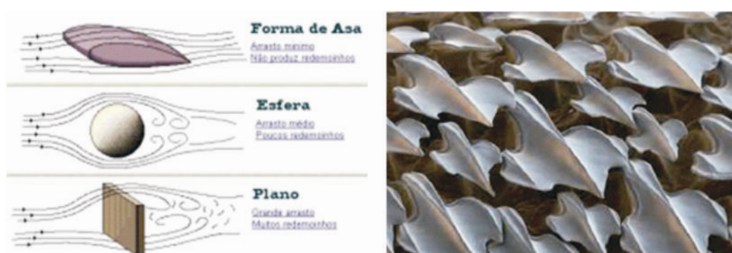
Figura 68 representação da força sobre a geometria dos corpos( interior da página), representação da escama hidrodinâmica do tubarão, http://images.google.com.br/imgres (12 de Junho 2009)
