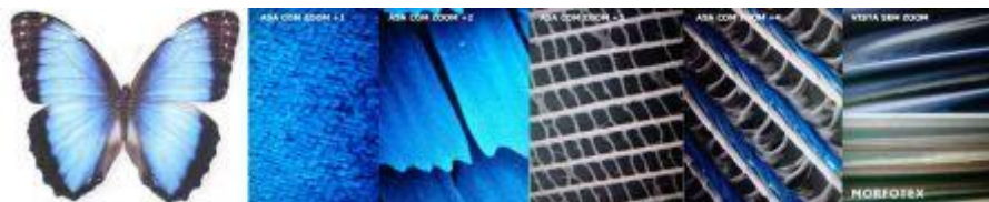
Figura 27 tecido Morfotex simulam essas microestruturas, dando origem a um tecido colorido sem a necessidade de tingimento e cuja coloração nunca se desbota ou altera.
