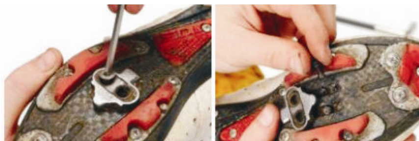
Figura 23 sistema de fixação do clips a sola da sapatilha fonte própria.
