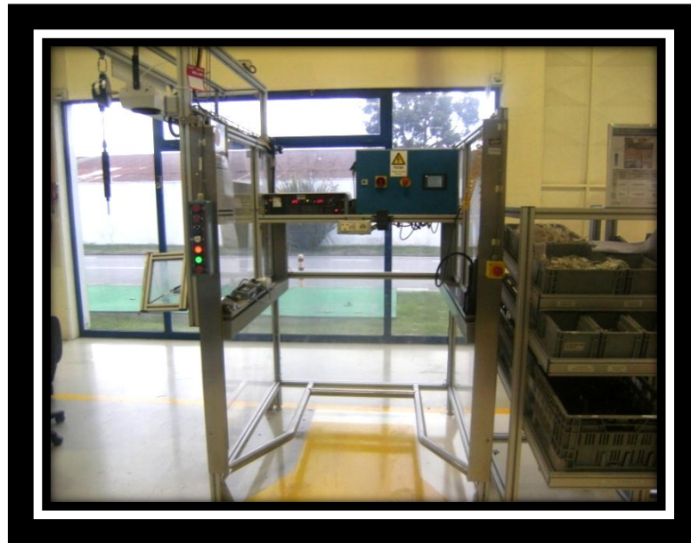
Figura 13 Posto de Rigidez Dielétrica
