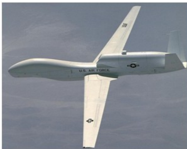
Figura 1: RQ-4 Global Hawk, um avião de altitude elevada e autonomia de 36 de voo.
