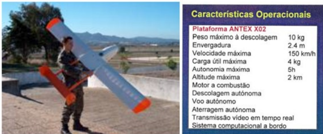
Figura 2: UAV Antex-X02 e suas características operacionais.
