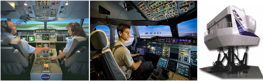
Figura 53: À esquerda uma plataforma de teste de voo da NASA, ao centro o cockpit de um simulador de teste da Airbus e à esquerda um simulador do Boeing.
