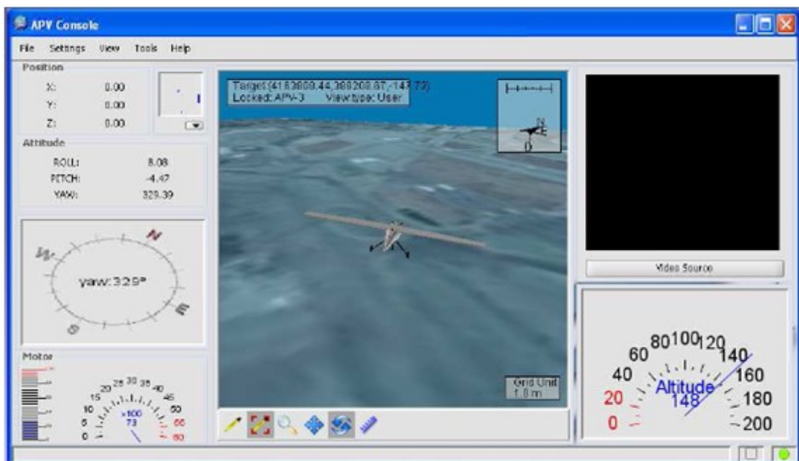
Figura 15: Exemplo de uma consola Neptus de comando.
