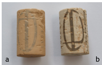
Figura 23 - a) Rolha revestida após a concretização da marcação por indução; b) Rolha marcada por indução sem revestimento;
