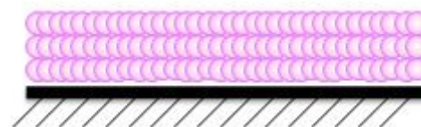
Figura 13 - Limite da distância entre partículas (exactamente antes do fenómeno de coalescência)
