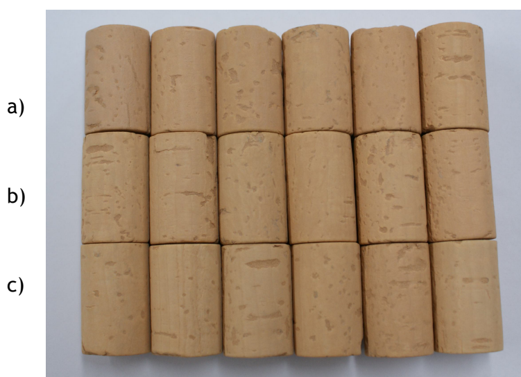
Figura 22 - a) Rolha colmatada revestida com 306 sem humidificação prévia; b) Rolha colmatada revestida com 306 com humidificação prévia; c) Rolha colmatada revestida com 306 com humidificação prévia
