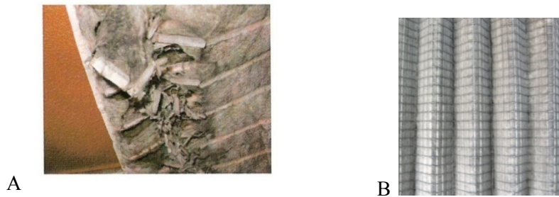
Figura 15 – Filtros: A – filtro degradado; B – filtro novo
