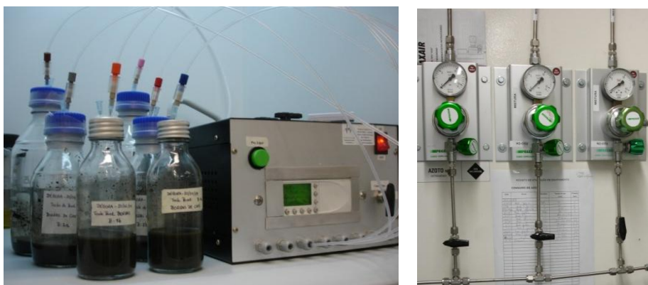
Figura 2.1 – Frascos de teste a serem refluxados com \text{N}_2/\text{CO}_2 (equipamento da Paralab) e sistema de gases
