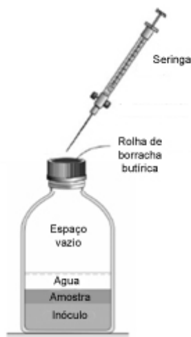
Figura 2.3 – Processo de amostragem do gás gerado no headspace (adaptado de ANGELIDAKI E SANDERS, 2004 e HANSEN et al, 2004)
