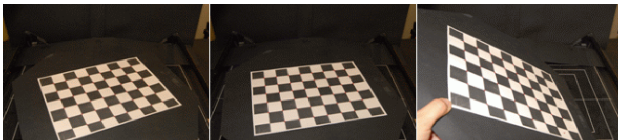
Figura 4. Três imagens exemplo de uma incorrecta extracção e ordenação automática dos vértices do padrão de calibração usado, mesmo sendo visíveis na imagem todos os seus vértices.
