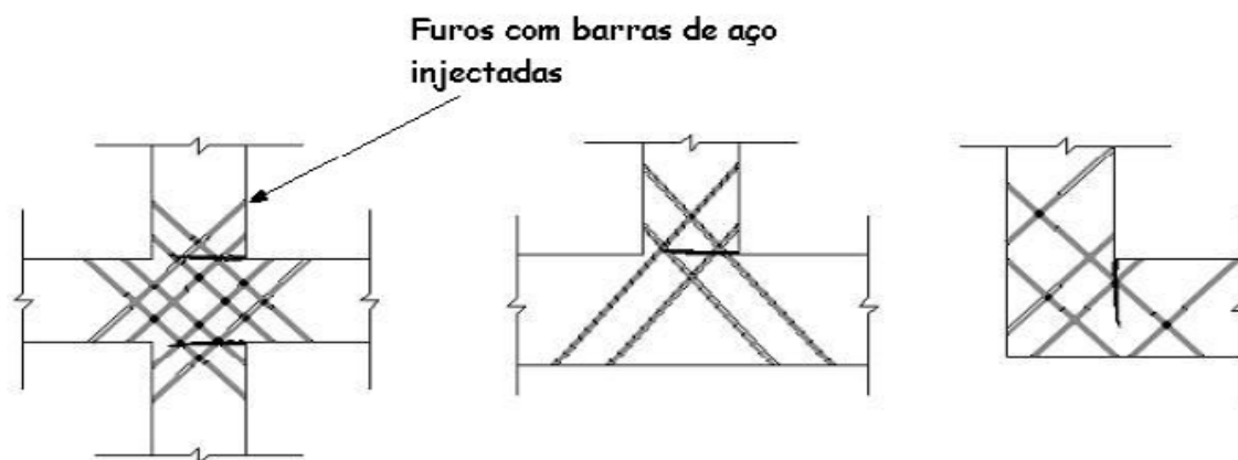
Fig.4.7 – Exemplos da melhoria de ligações entre paredes com pregagens em direcções cruzadas [Roque, 2002].
