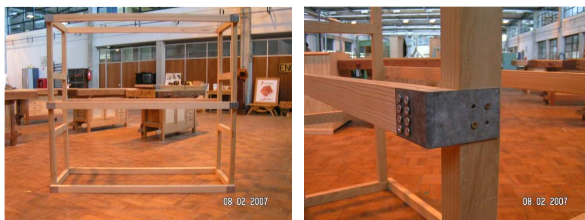
Fig.6.5 – “Gaiola” de madeira utilizada para reforço da parede de alvenaria ensaiada.
