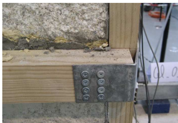
Fig.6.21 – Comportamento das ligações observado durante o ensaio.
