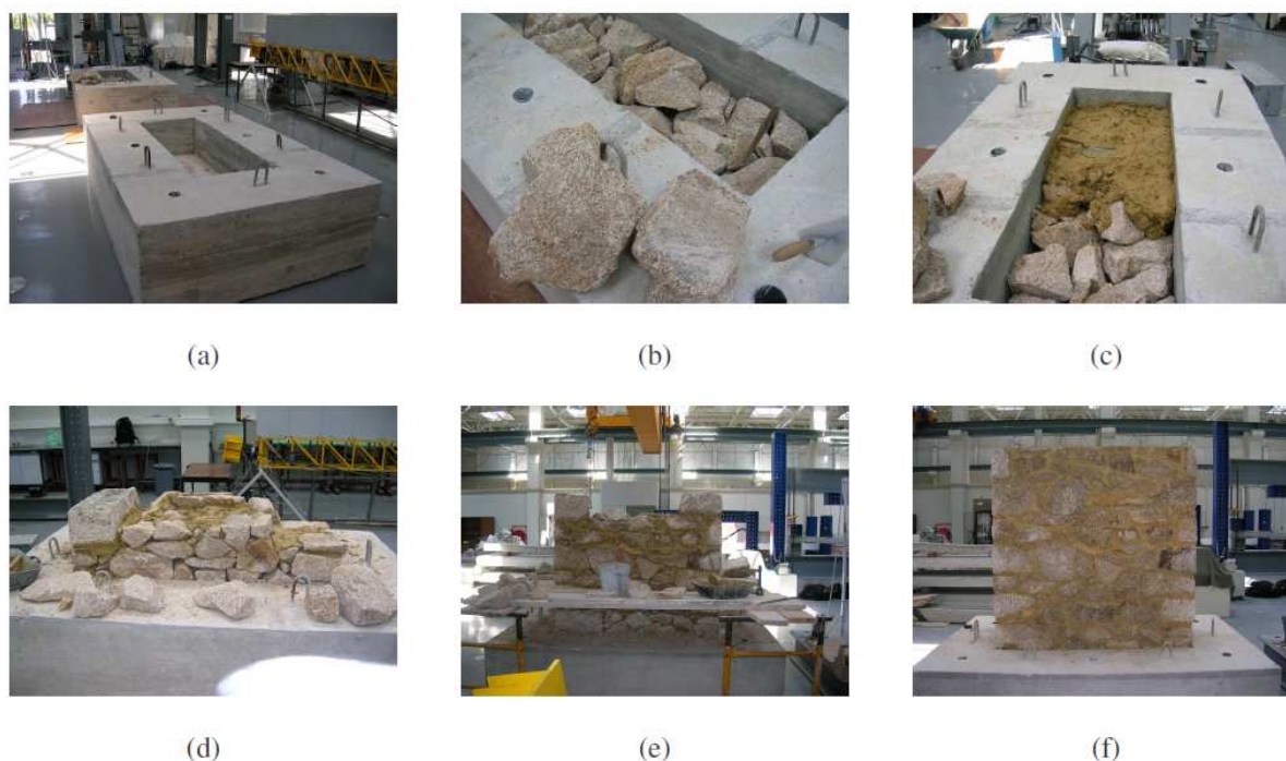
Fig.6.4 – Fases de construção da parede PA1NR [Silva, 2008].
