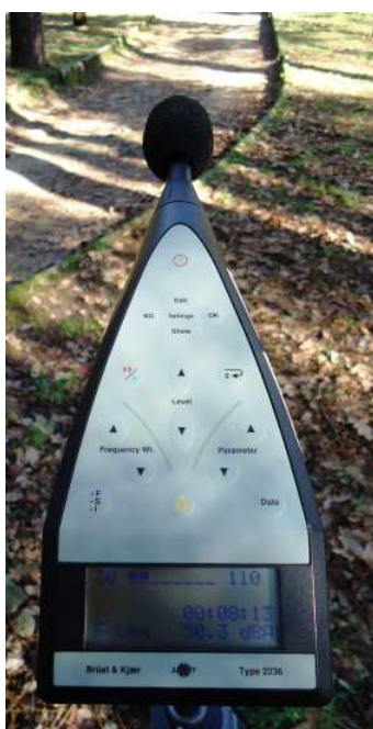
Fig. 4.5.: Sonómetro da Brüel & Kjær , modelo 2236, classe 1, com microfone acoplado e protegido [fotografia do autor].
