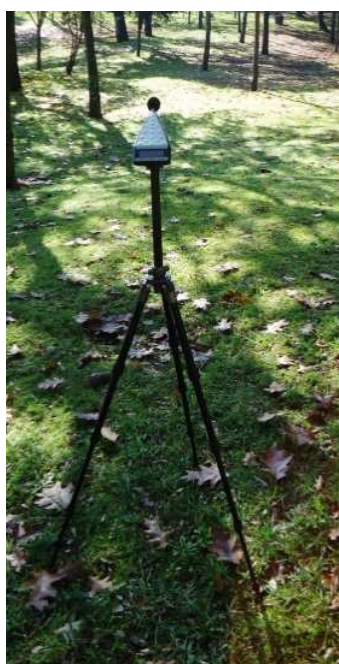
Fig. 4.6.: Sonómetro e tripé emparelhados, durante uma medição in situ [fotografia do autor].
