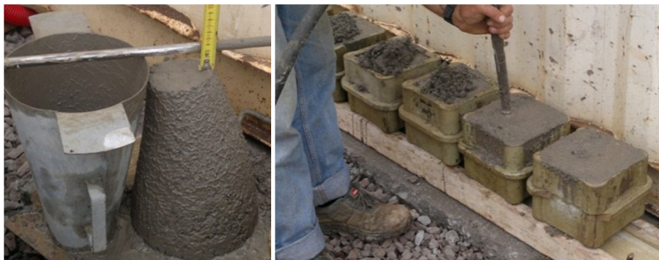
Figura 5.6 – Ensaio e recolha de amostras de betão
