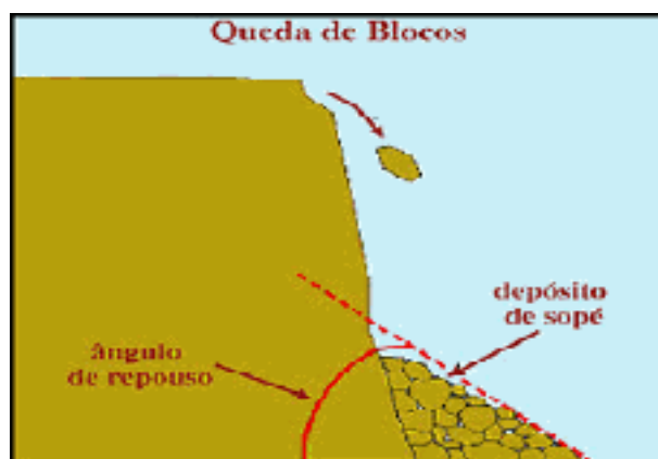
FIGURA 1A - QUEDA DE BLOCOS FONTE: (PEREIRA J. , 2010)
