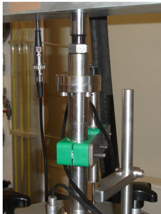
Figura 4.2 – a) Prensa cíclica do LabGeo – FEUP; b) Pormenor da união do êmbolo ao atuador
