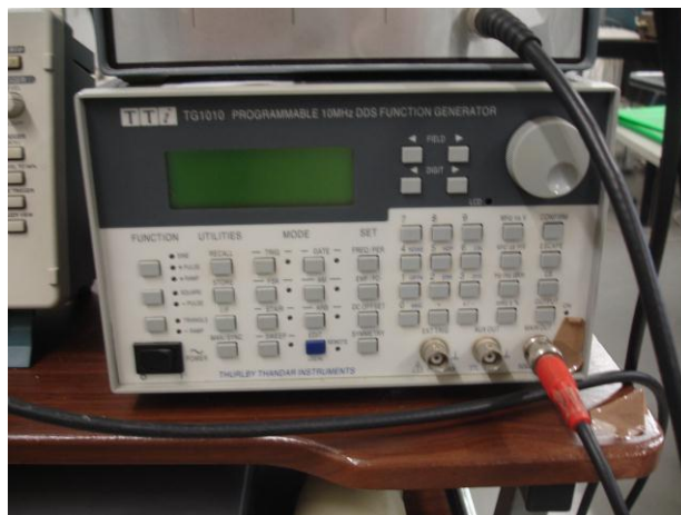
Figura 4.7 – Gerador de funções Thurlby Thandar Instruments TTI TG 1010 ®
