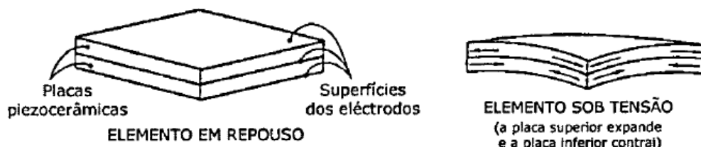
Figura 4.12 – Esquema de um elemento piezocerâmico duplo em repouso e sob tensão (Ferreira, 2003)
