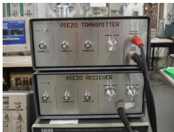
Figura 4.8 – Amplificador de sinal UWA
