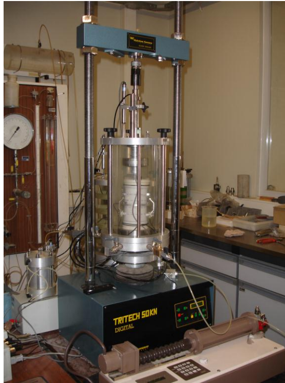
Figura 4.4 – Prensa estática Wykeham Farrance 50 kN ®
