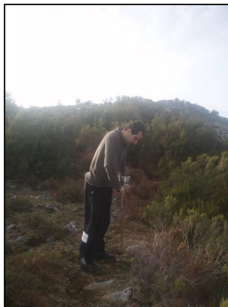
FIGURA 5.6 – Ensaio de Resistência do Solo in situ
