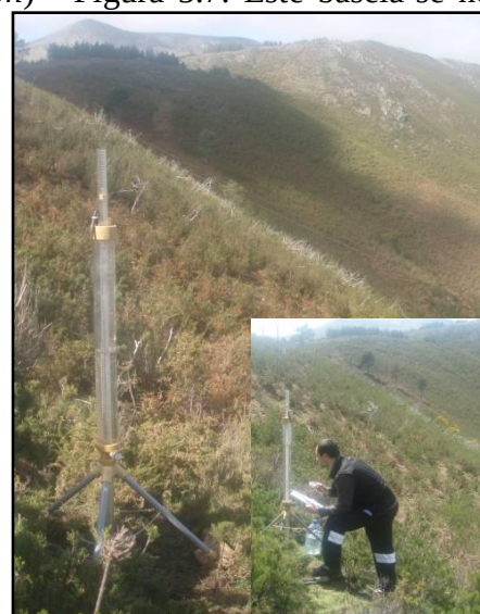
FIGURA 5.7 - Medição da Permeabilidade do Solo in situ
