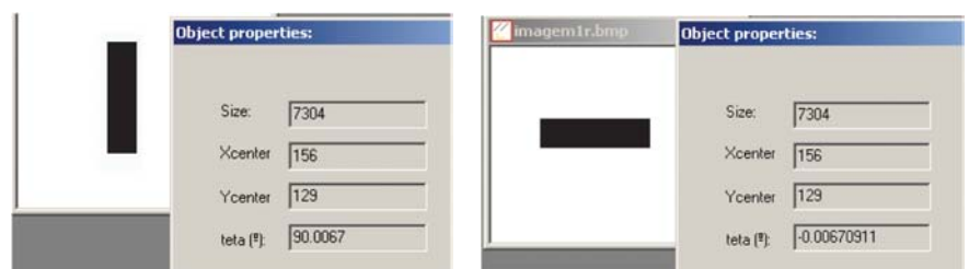
Figure 3 Determinação da área, das coordenadas do centróide e da orientação de dois objectos através do método dos momentos.
